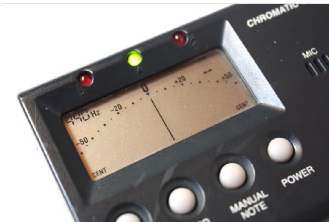
Figura 49 "Led verde acceso = Corretta accordatura"
