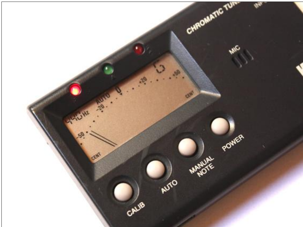
Figura 50 "Led rosso a sinistra acceso = nota bemolle"
