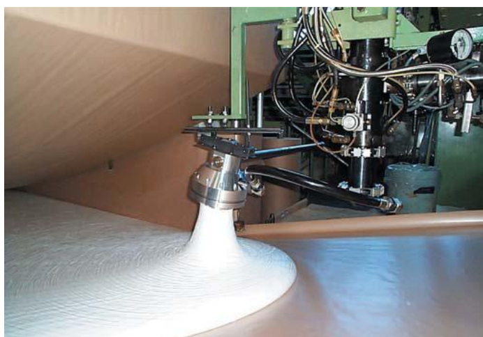
Figura 1.14 – Particolare della testa di miscelazione di un impianto di schiumatura in continuo [1,2] .
