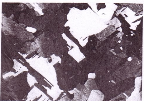
Fig. 3.8 Struttura grana grossa di una lega Ferro Nickel (45%-50%)
