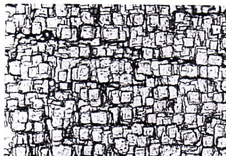
Fig. 3.7 Allineamento cristallino in una struttura cubica
