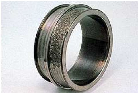
Figura 1.9: Cuscinetto a sfere. Flaking solo da un lato dell'anello interno a causa carico assiale eccessivo.
