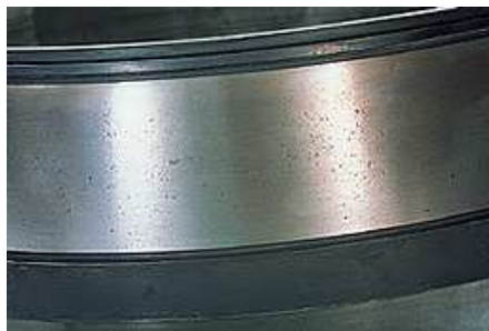
Figura 1.29: Anello interno di un cuscinetto a rulli conici. Le indentazioni sono visibili sulla superficie della pista, sono causate della presenza di corpi solidi interposti tra i rulli conici e la pista di rotolamento.
