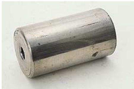
Figura 1.16: Rulli di un cuscinetto a rulli cilindrici. Spalling, in direzione assiale, della superficie del rullo causata durante il montaggio del cuscinetto.
