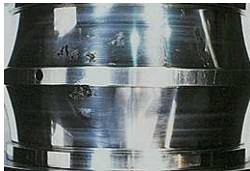
Figura 1.41: Anello interno di un cuscinetto a rulli. Corrosione della pista di rotolamento a causa della presenza di acqua nel lubrificante.
