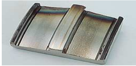
Figura 1.26: Anello interno di un cuscinetto a rulli cilindrici. Le indentazioni sono presenti su un solo lato della pista a causa della presenza di corpi solidi interposti tra i rulli e la pista di rotolamento.
