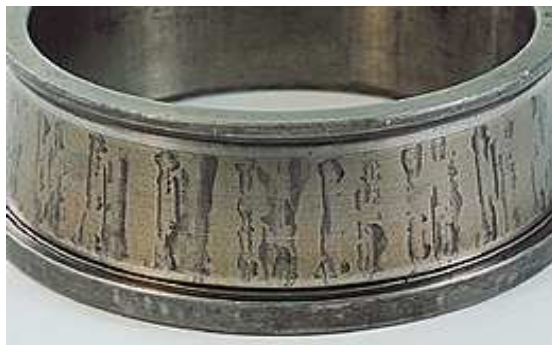
Figura 1.38: Anello interno di un cuscinetto a rulli conici. Corrosione della pista di rotolamento a causa della presenza di acqua nel lubrificante.
