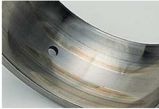
Figura 1.32: Anello esterno di un cuscinetto a rulli a botte. Parziale deposizione di olio sulla superficie della guida.
