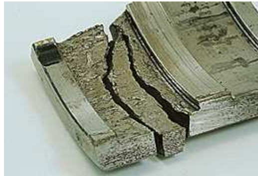
Figura 1.43: Anello esterno di un cuscinetto a rulli cilindrici. Suddivisione, in direzione circonferenziale, della pista di rotolamento a causa di un elevato sfaldamento.
