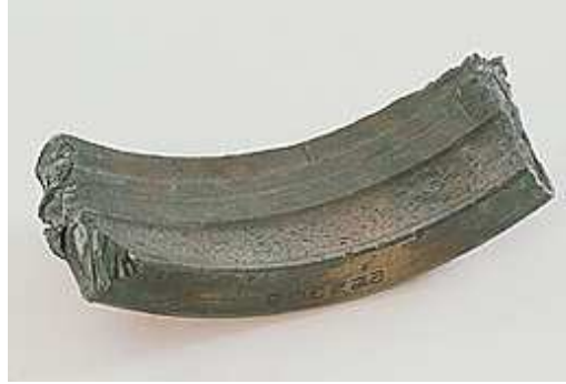
Figura 1.36: Anello esterno di un cuscinetto a rulli a botte. Il grippaggio è dovuto ad una scarsa lubrificazione.
