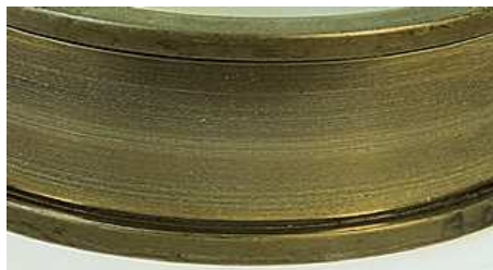
Figura 1.30: Anello interno di un cuscinetto a rulli conici. La superficie è macchiata a causa del pitting elettrico.
