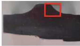
Figura 3.37: Sezione longitudinale della pista “MS” distante dal danno macroscopico più grande.
