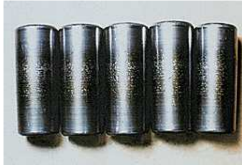
Figura 1.46: Rulli conici. Il pitting elettrico si verifica nel mezzo della superficie di contatto dei rulli.
