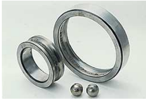
Figura 1.7: Cuscinetto a sfere. Il flaking si manifesta sull'anello interno l'anello esterno e le sfere a causa del carico eccessivo.
