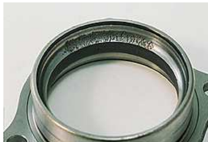
Figura 1.10: Cuscinetto a sfere. Flaking di un quarto della pista dell'anello esterno per via di una installazione errata del cuscinetto.
