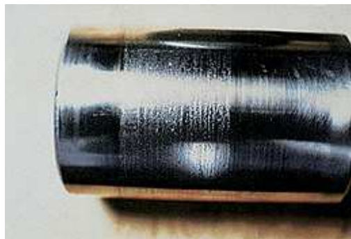
Figura 1.18: Rullo cilindrico del cuscinetto mostrato in Fig 1.17. Lo smearing sulla superficie del rullo è causata dalla presenza di detriti, intrappolati tra i rulli, che provocano lo slittamento dei rulli.
