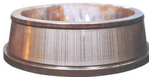
Figura 1.48: Anello interno di un cuscinetto a rulli conici. Le scanalature sulla superficie della pista sono causate dalla corrosione elettrica “flutting”.
