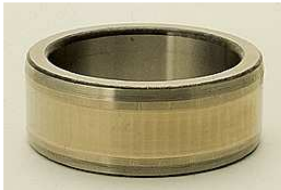
Figura 1.22: Anello interno di un cuscinetto a rulli cilindrici. A causa delle vibrazioni, su tutta la superficie della pista di rotolamento è presente fretting wear.
