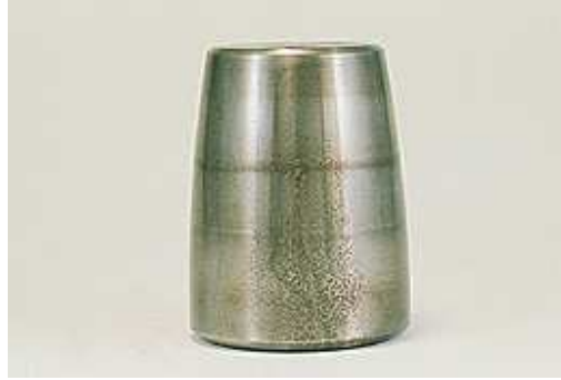
Figura 1.40: Rullo a botte. Corrosione della superficie di contatto del rullo a causa dell'ingresso di acqua nel cuscinetto.
