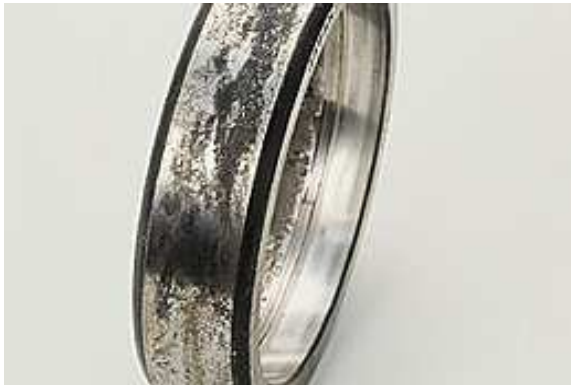
Figura 1.24: Anello esterno di un cuscinetto a rulli cilindrici. In corrispondenza del diametro esterno dell'anello, tutta la superficie presenta fretting corrosion.
