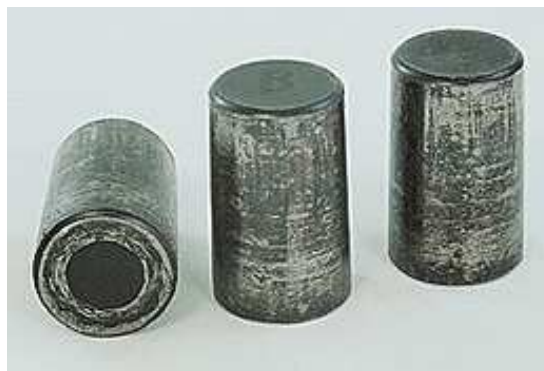
Figura 1.35: Rulli conici appartenenti all'anello interno mostrato in figura 1.34. A causa del grippaggio, i rulli hanno subito una perdita di colore, una scheggiatura e una adesione.
