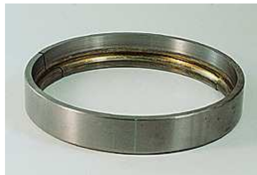
Figura 1.44: Anello esterno di un cuscinetto a sfere a contatto obliquo. Suddivisione della superficie della pista in direzione circonferenziale a causa dello slittamento della sfere e della scarsa lubrificazione.
