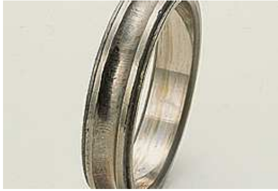
Figura 1.23: Anello interno di un cuscinetto a sfere. A causa delle vibrazioni, su tutta la superficie della pista di rotolamento è presente fretting wear.
