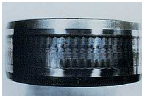
Figura 1.45: Anello interno di un cuscinetto a rulli cilindrici. La superficie della pista risulta ondulata a causa del pitting elettrico.
