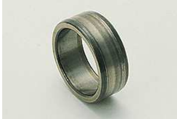
Figura 1.20: Anello interno di un cuscinetto a rulli cilindrici. Lungo tutta la circonferenza sono evidenti segni di usura della pista di rotolamento, a causa di una scarsa lubrificazione.
