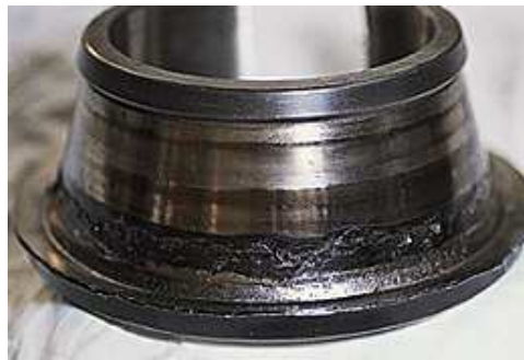
Figura 1.37: Anello interno di un cuscinetto a rulli conici. Grippaggio avvenuto per carico eccessivo e lubrificazione inadeguata.
