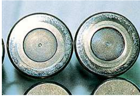
Figura 1.15: Rulli di un cuscinetto a rulli conici. Spalling circolare sulla faccia dei rulli per via di una cattiva lubrificazione.
