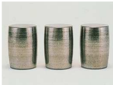
Figura 1.27: Rulli a botte di un cuscinetto a rulli. Le indentazioni sono presenti sulla superficie di contatto dei rulli a botte a causa della presenza di corpi solidi interposti tra i rulli e la pista di rotolamento.
