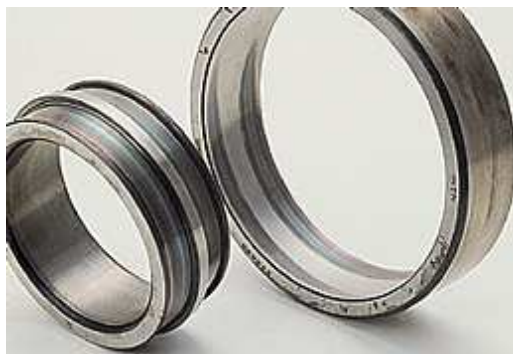
Figura 1.33: Anello interno ed esterno di un cuscinetto a rulli a botte. La perdita di colore della superficie, della pista dell'anello interno ed esterno, è causata dalla deterioramento del lubrificante.
