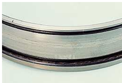
Figura 1.14: Anello interno di un cuscinetto a rulli cilindrici. Spalling della superficie della pista di rotolamento per una scarsa lubrificazione.
