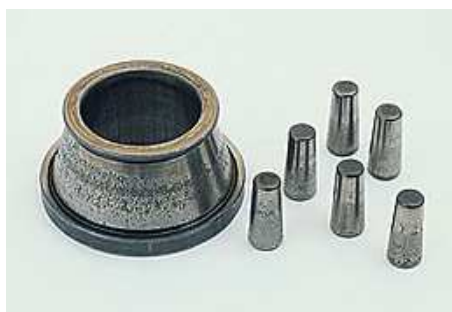
Figura 1.12: Cuscinetto a rulli conici. Peeling presente sia sull'anello interno che sui rulli conici per via di una scarsa lubrificazione.
