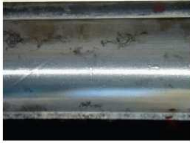
Figura 3.5: Difetti secondari individuati lontano dai danni principali.
