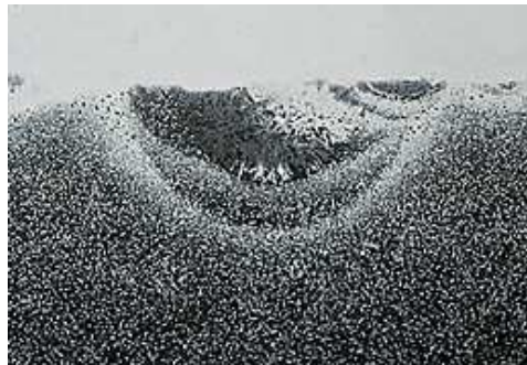
Figura 1.47: Ingrandimento del pitting elettrico relativo ai rulli di figura 1.46.
