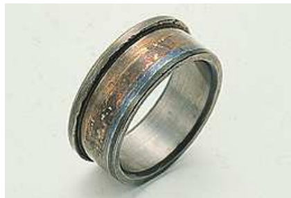
Figura 1.13: Cuscinetto a rulli cilindrici. Spalling dell'orlo per un carico eccessivo.
