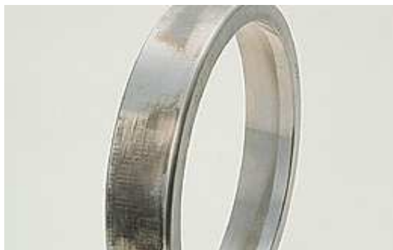
Figura 1.25: Anello esterno di un cuscinetto a rulli conici. In corrispondenza del diametro esterno dell'anello, tutta la superficie presenta fretting corrosion.
