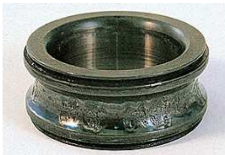
Figura 1.8: Cuscinetto a sfere. Flaking dell'anello interno a causa di un carico assiale eccessivo.
