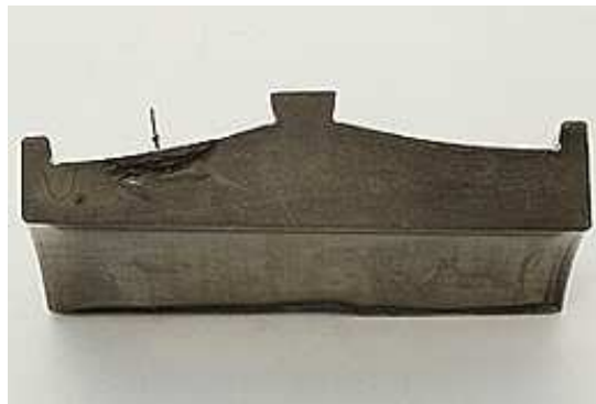
Figura 1.42: Anello interno di un cuscinetto a rulli a botte. La rottura è causata da una eccessiva interferenza, il punto di origine della cricca si osserva nel mezzo della superficie della pista di sinistra.
