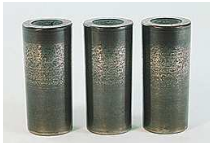
Figura 1.28: Rulli conici di un cuscinetto a rulli. Le indentazioni sono su tutta la superficie di contatto dei rulli conici a causa di corpi solidi presenti all'interno del lubrificante.
