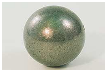
Figura 1.31: Sfera di un cuscinetto a sfere. Le macchie sono ovunque, sono causate da una scarsa lubrificazione e dalla presenza di corpi solidi interposti tra le sfere e la pista di rotolamento.
