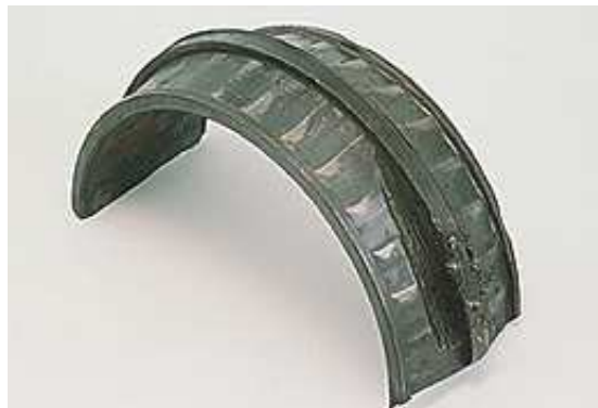
Figura 1.34: Anello interno di un cuscinetto a rulli conici a doppia fila. La causa del grippaggio è una scarsa lubrificazione.
