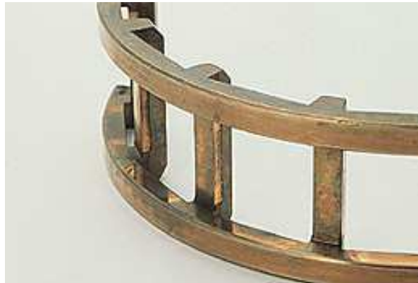
Figura 1.21: Gabbia di un cuscinetto a rulli cilindrici. Usura da abrasione della gabbia in ottone.
