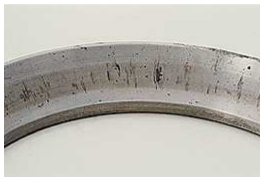
Figura 1.39: Anello esterno di un cuscinetto a rulli conici. Corrosione della pista di rotolamento a causa della presenza di acqua nel lubrificante.
