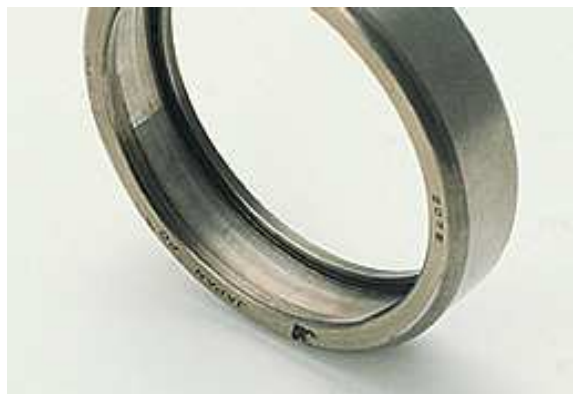
Figura 1.19: Anello esterno di un cuscinetto a rulli cilindrici. Segni di usura sulla superficie della pista di rotolamento a causa di una scarsa lubrificazione.
