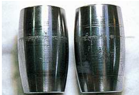
Figura 1.11: Rulli a botte. Peeling tondeggiante sui rulli a botte del cuscinetto per via di una scarsa lubrificazione.
