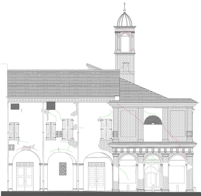
Figura 4.1: prospetto dell'ospitale e della chiesa su via Santa Maria. Sono visibili le piastre per le catene provvisorie inserite dal ingegnere Teneggiani dopo il sisma del 2000 per contenere il ribaltamento della facciata.
