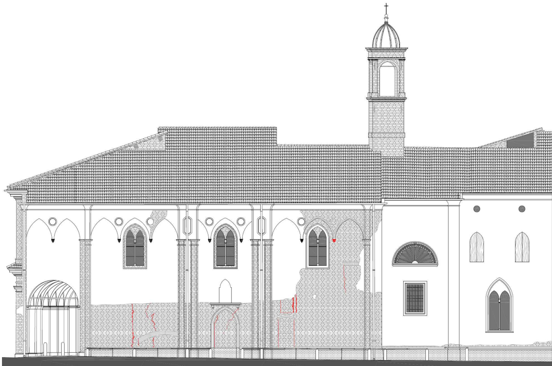
Figura 4.12: Rilievo architettonico del prospetto settentrionale su via Borgovecchio. In rosso sono evidenziate le lesioni e le discontinuità murarie.
