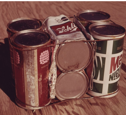
Illustrazione 57: blocco costruttivo di lattine di metallo recuperate.
