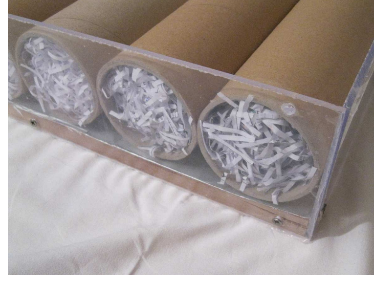
immagini realizzazione pannelli per prova termica
