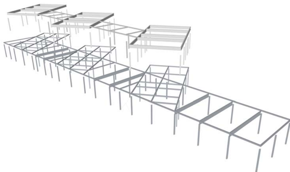
33_Modello 3D della struttura portante
