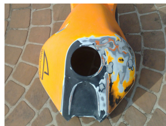
Img. 72 Riparazione di un serbatoio in vtr
