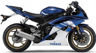
Img. 88 - 89 - 90 Esempi di scarichi sottocoda su modelli degli ultimi anni
