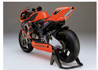
Img. 84 - 85 - 86 - 87 Esempi di scarichi sottocoda su modelli degli ultimi anni
