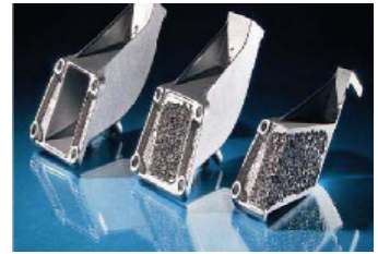
Img. 61 Sezione di un particolare del telaio riempito con schiuma metallica
