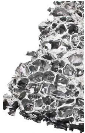
Img. 62 Superficie di schiuma metallica
