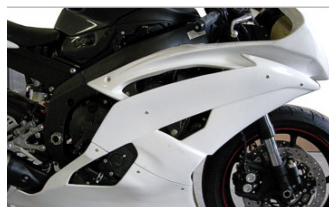
Img. 128 Plastic Bike: componenti in vetroresina
