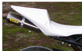
Img. 129 Plastic Bike: componenti in vetroresina
