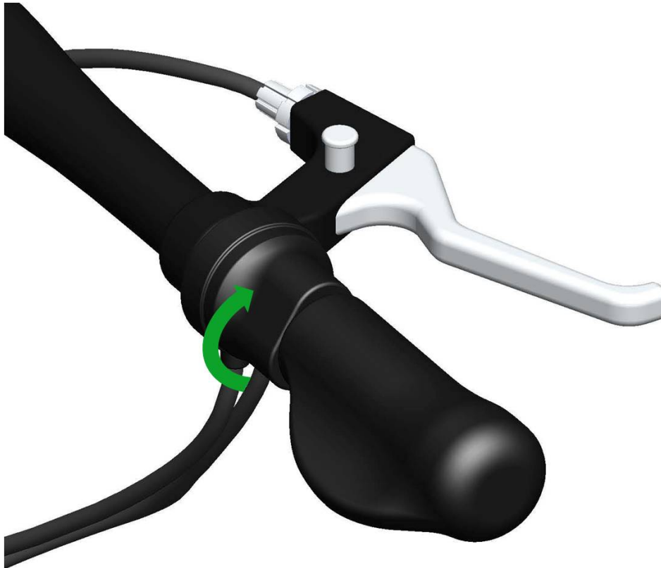
Immagine 154: Comando a rotazione del cambio posteriore
