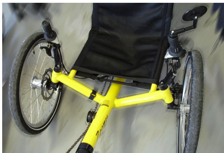
Immagine 102: Sistema Axle Pivot Steering
