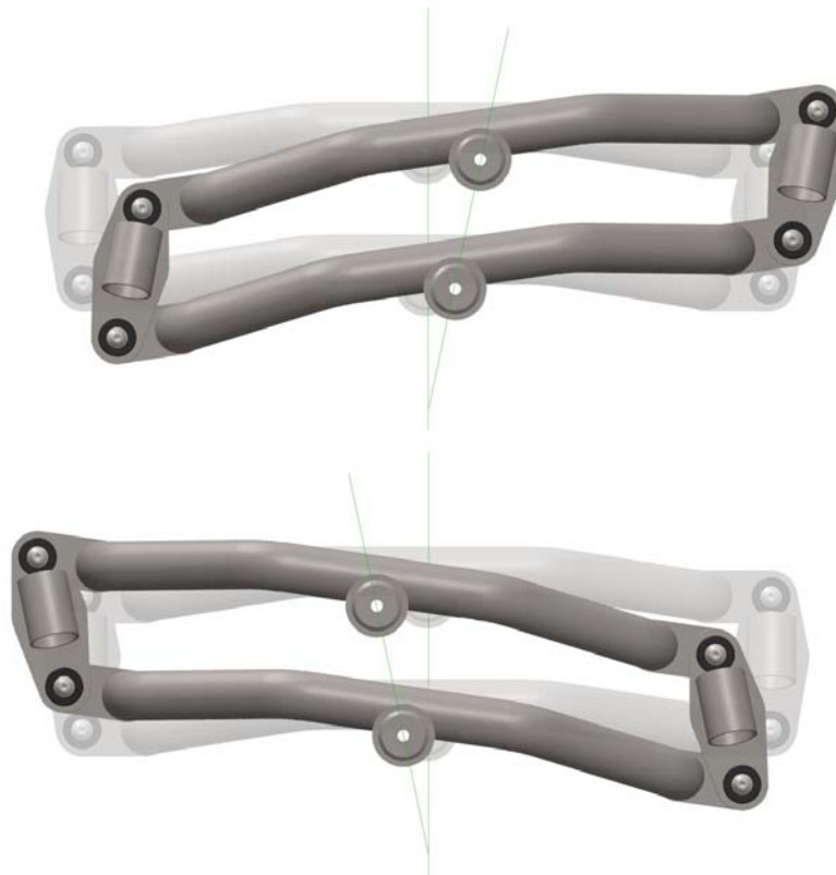
Immagine 148: Inclinazione del sistema a parallelogramma
