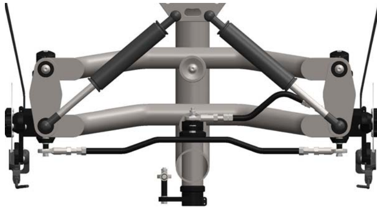
Immagine 149: Posizione delle molle e delle bacchette
