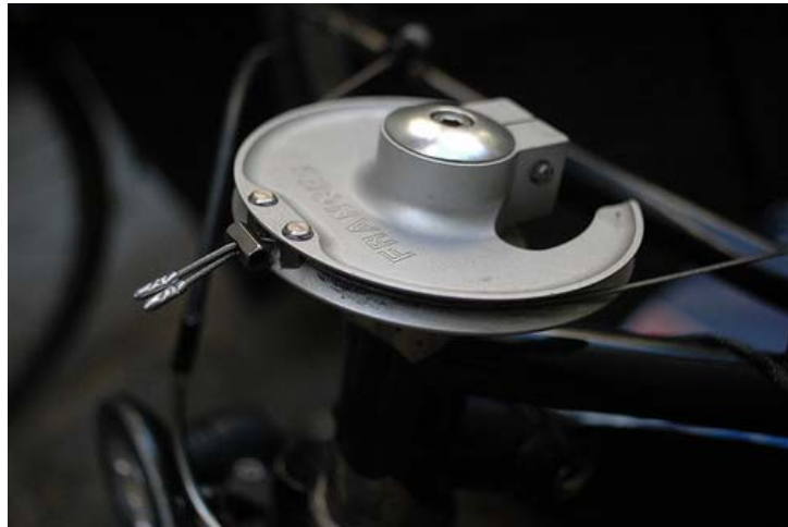
Immagine 51: Sistema sterzo a cavi
