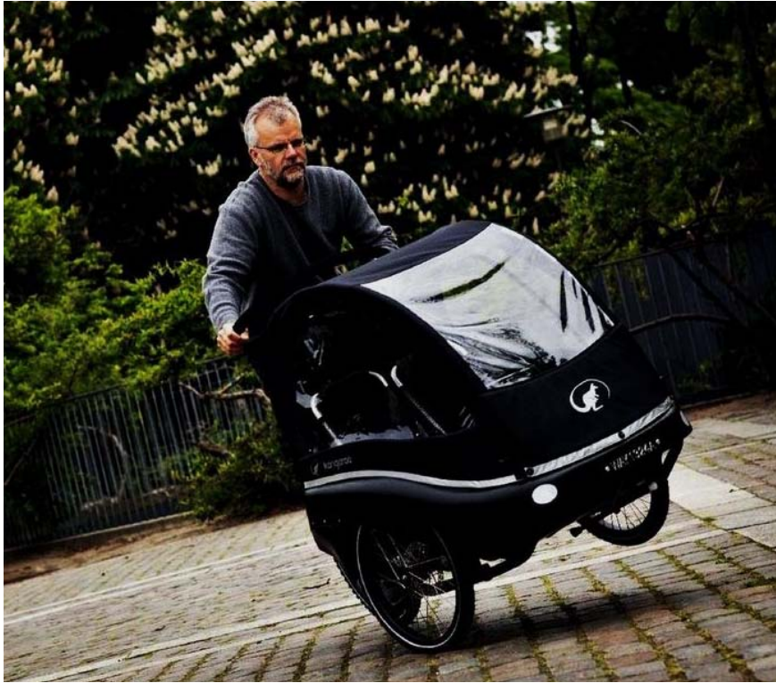
Immagine 95: Rischio di cappottamento dei tricicli convenzionali
