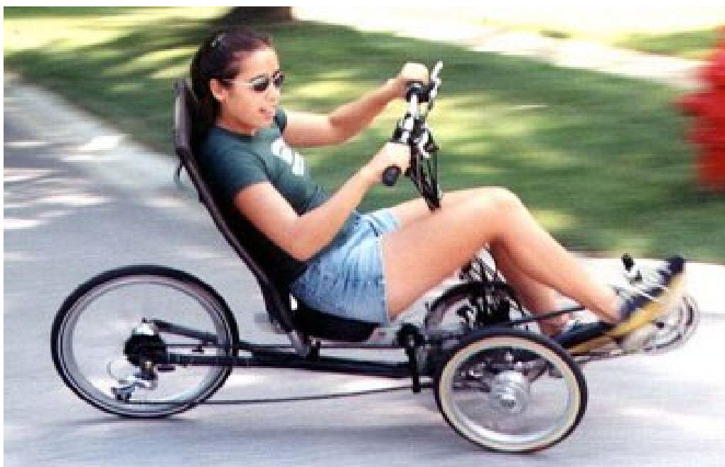
Immagine 105: Bicicletta reclinata con sistema Parallelogramma
