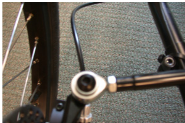
Immagine 112: Connessione per mezzo di snodi sferici
