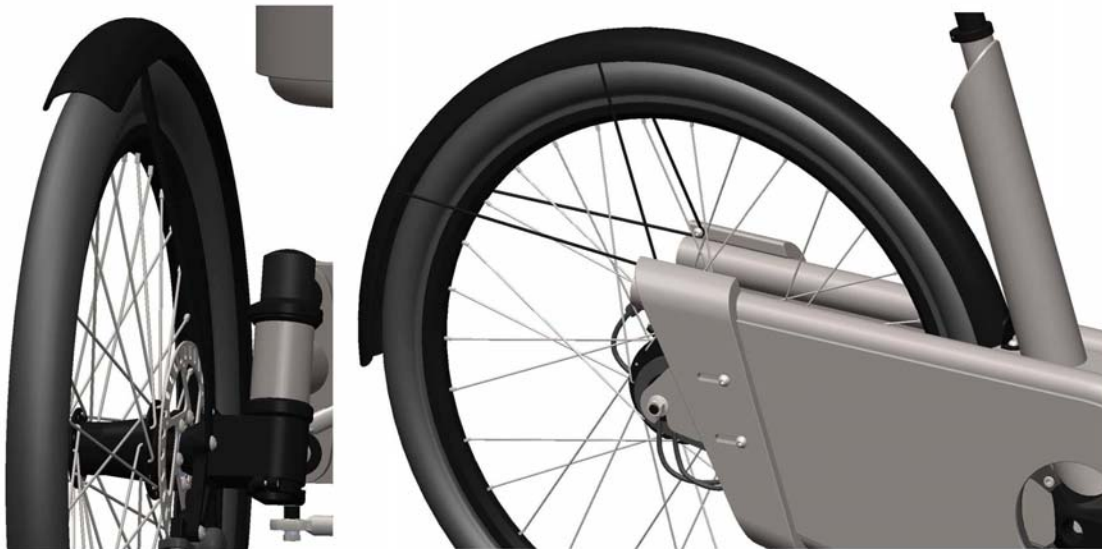
Immagine 179: Punti di fissaggio dei parafranghi
