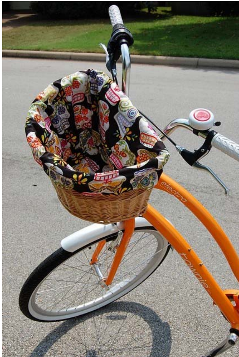
Immagine 62: Bicicletta con carico sopra la ruota attaccato alla forcella
