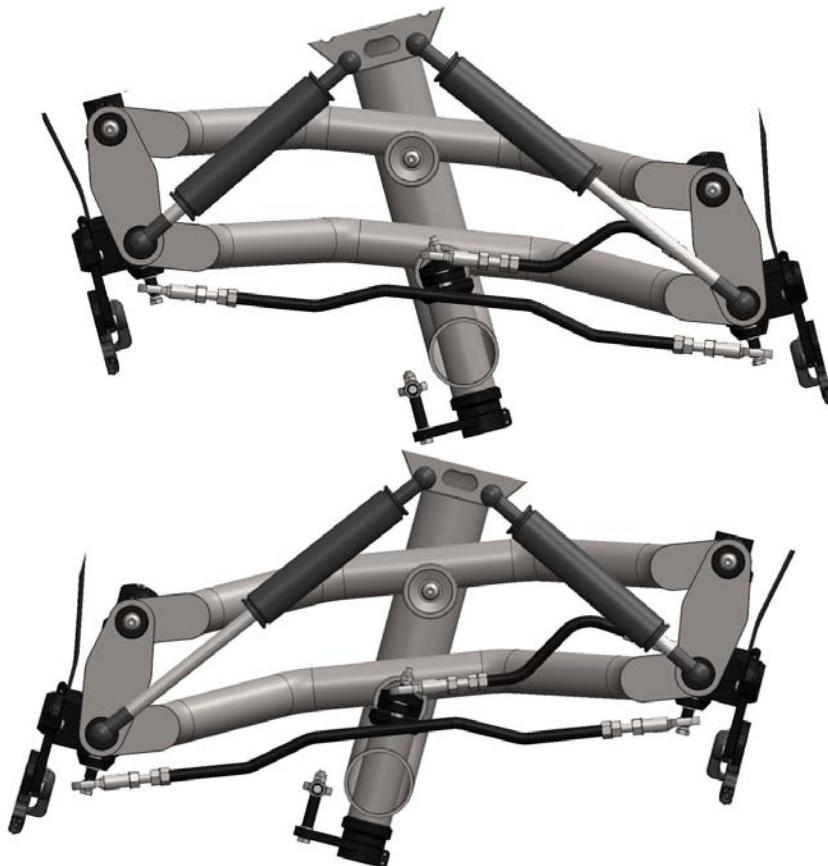
Immagine 150: Posizione inclinata delle molle e delle bacchette
