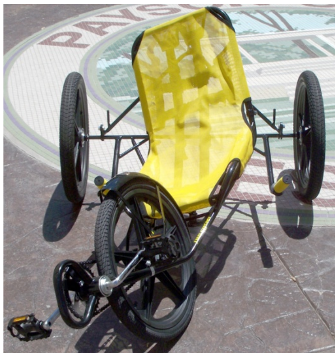
Immagine 106: Triciclo reclinato con sistema Pivot Frame
