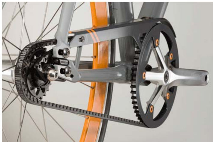
Immagine 119: Trasmissione a cinghia dentata
