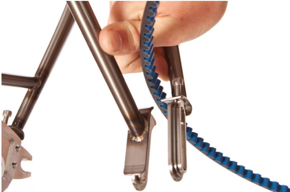
Immagine 110: Apertura dei foderi per la installazione della cinghia
