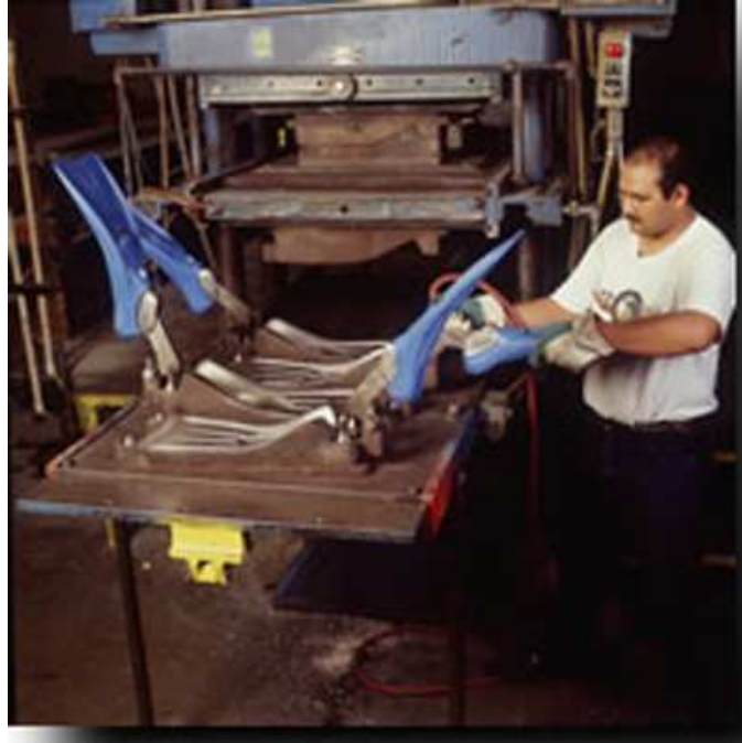
Stampaggio mediante stampi riscaldati di pinne
