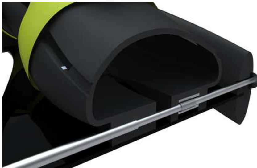
Sistema di regolazione della larghezza della scarpetta per mezzo di una vite che agisce su un inserto filettato
