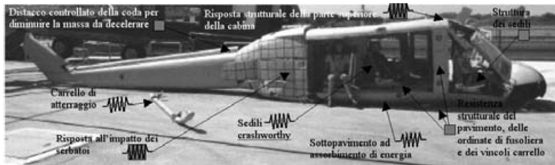
Figura 2 Impatto in condizioni di crash di una struttura d'elicottero.
