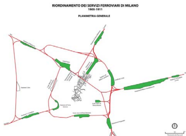
Fig.2 Riordinamento dei servizi ferroviari di Milano (1905-1911). Di noti come la stazione Centrale diventi ora stazione di testa, si chiude l'anello ferroviario che avvolge la città di Milano e i due scali (Sempione e Garibaldi) vengono dismessi in favore del nuovo scalo Farini con il conseguente abbandono dei collegamenti della Centrale con Porta Garibaldi e con Porta Sempione, e di costruire le linee di raccordo degli impianti milanesi in modo tale da consentire l'espansione edilizia secondo il piano regolatore della città, senza ostacolare la viabilità.
