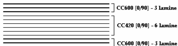
Figura 4.8 Sequenza di laminazione per la terza infusione
