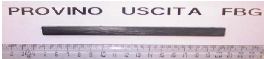
Figura 4.16 Provino tagliato per individuare il punto di uscita del sensore FBG
