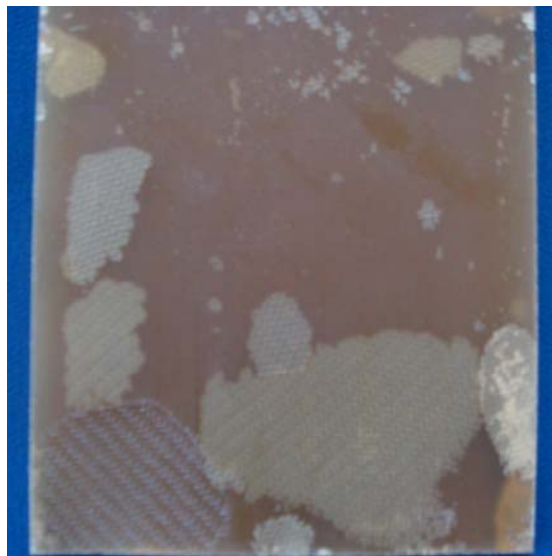
Figura 4.7 Particolare delle zone non impregnate del laminato
