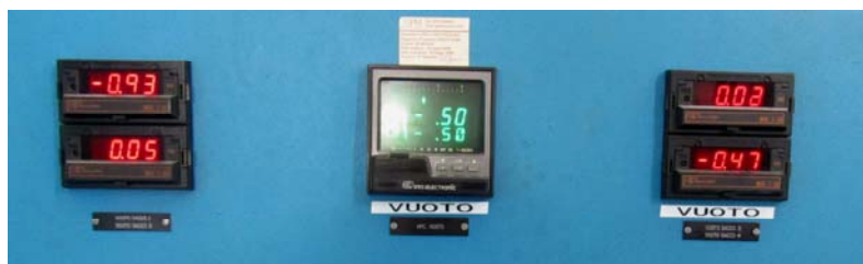
Figura 3.1 Indicatori di pressione con valori tipici durante un'infusione
