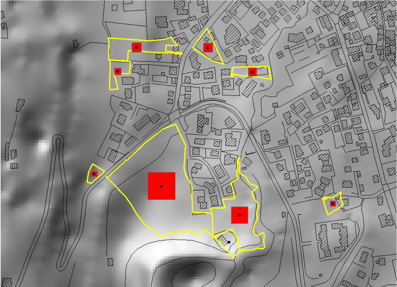
Fig. 24 - I sedimi rappresentativi degli ipotetici edifici realizzabili sono rappresentati da parallelepipedi a base quadrata. Convertito lo shape file poligonale delle istanze (giallo) in centroide puntuale (nero), sono stati generati i quadrati (in rosso) centrati nel baricentro di ogni istanza e aventi come lato la misura ottenuta dalla radice quadrata del rapporto tra il volume massimo e l'altezza massima = superficie massima dell'edificio realizzabile.
