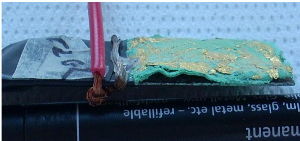
Figura 71: distacco della patina a seguito della prova
