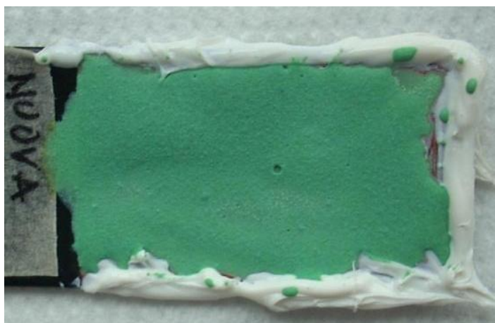
Figura 10:immagine della patina contenente cloruri e solfati
