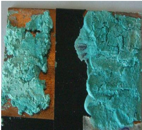
Figura 83: patina di \text{CuSO}_4 e \text{Cu}(\text{OH})_2 (rapporto polvere/acqua di 2)
