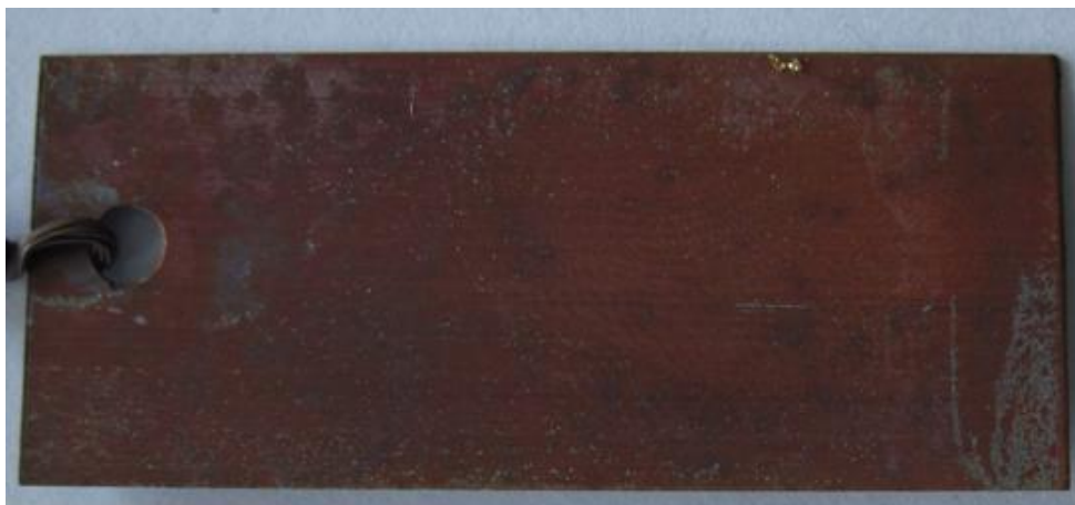
Figura 96: campione dopo 1 settimana di immersione continua in pioggia artificiale
