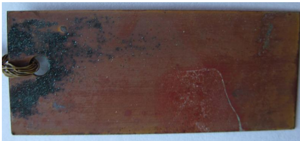
Figura 100: campione dopo 3 settimane di cicli di immersione in pioggia artificiale
