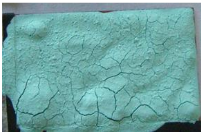
Figura 84: patina di \text{CuSO}_4 e \text{Cu}(\text{OH})_2 (rapporto polvere/acqua di 0,7)
