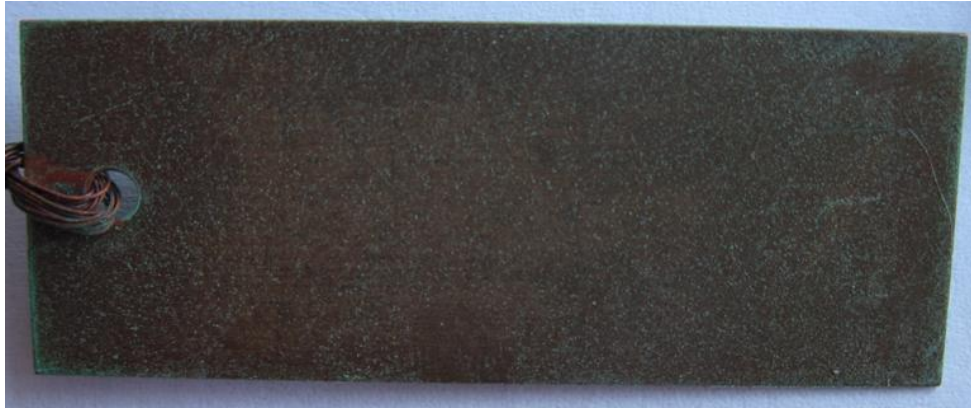
Figura 91: campione dopo 2 settimane di immersione in soluzione di NaCl
