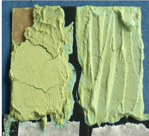
Figura 74: patina di CuCl (rapporto polvere/acqua di 1,5 e 1,3 rispettivamente)
