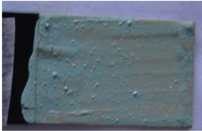
Figura 75: patina di CuCl (rapporto polvere/acqua di 0,7)
