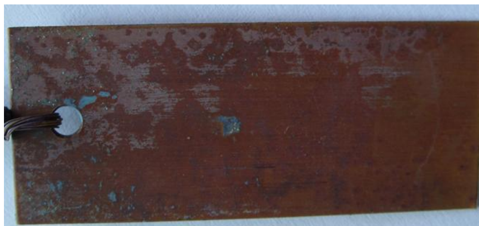
Figura 97: campione dopo 3 settimane di immersione continua in pioggia artificiale
