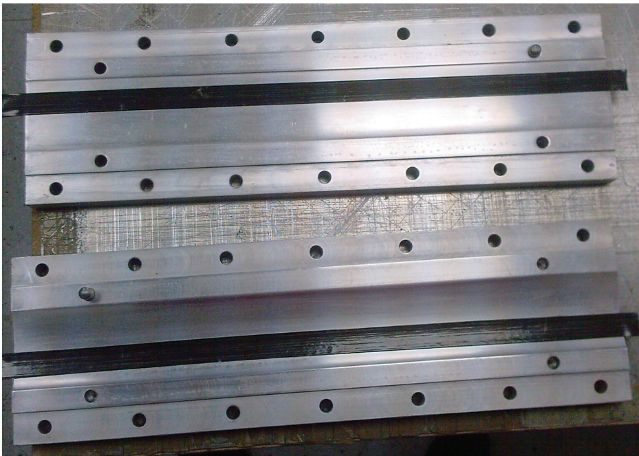
Figura 3.5.: Fase di laminazione: posa delle strisce di carbonio sullo stampo
