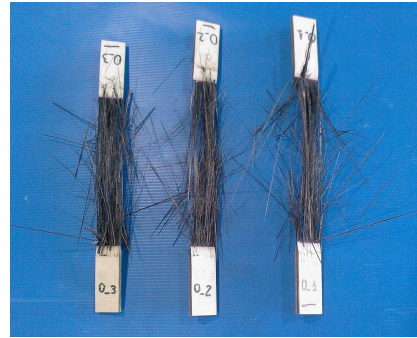
Figura A.1.: Provini fibra di carbonio a 0° portati a rottura
