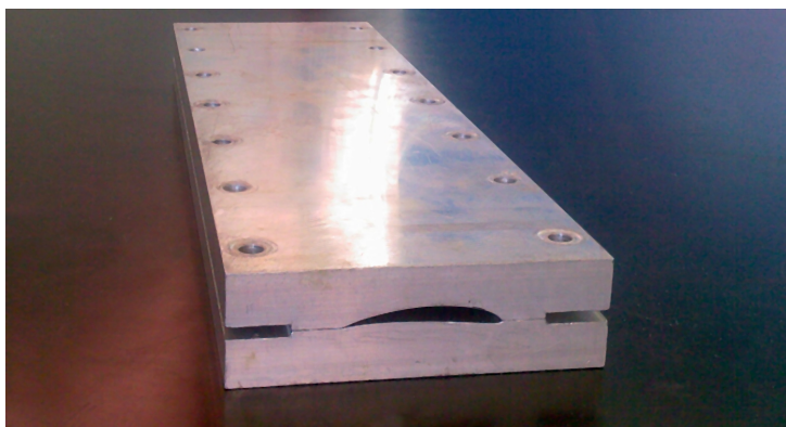
Figura 3.2.: Stampo utilizzato per la laminazione dei provini
