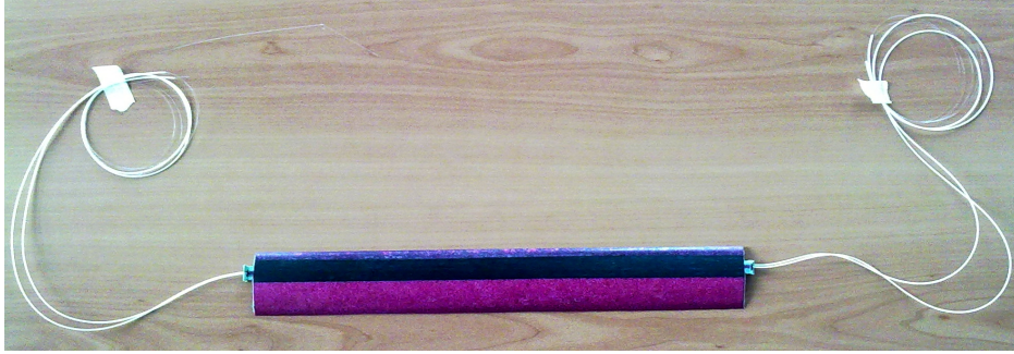
Figura 5.2.: Provino 1 con fibre ottiche passanti
