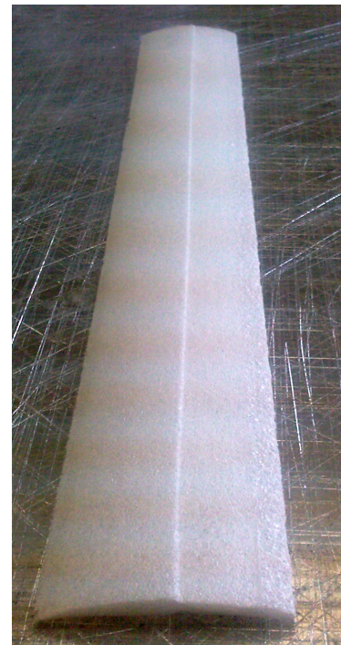
Figura 3.4.: Rohacell sagomato con la macchina a filo caldo
