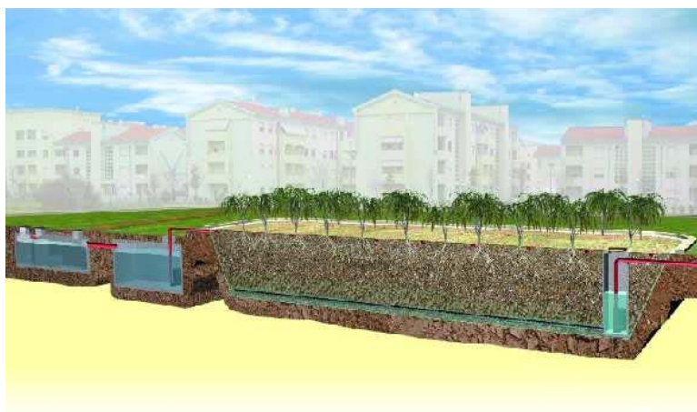
Fig. 65: Sistema trattamento fitodepurazione
