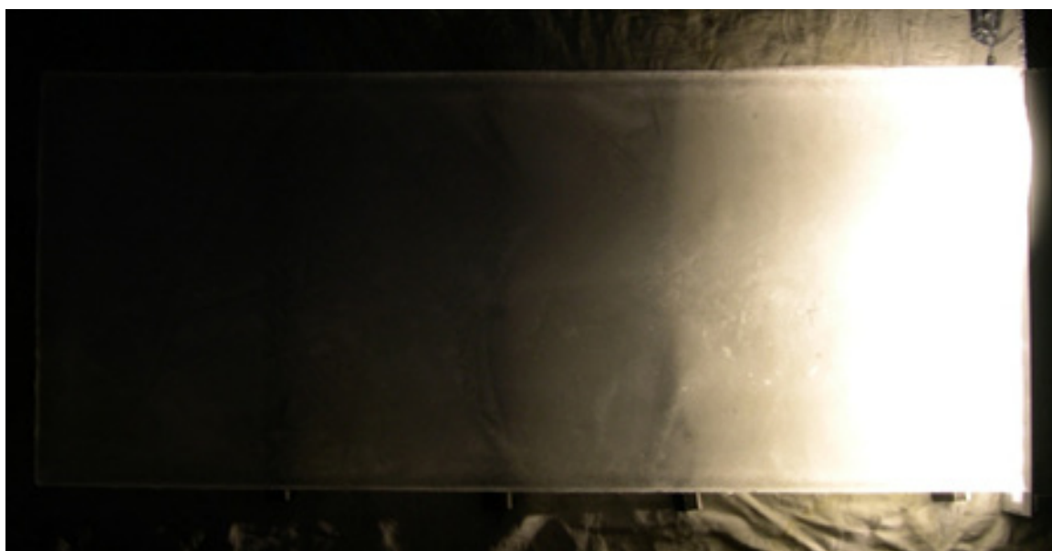
Figura 44: il fenomeno della diffusione della luce attraverso la lastra di ghiaccio campione
