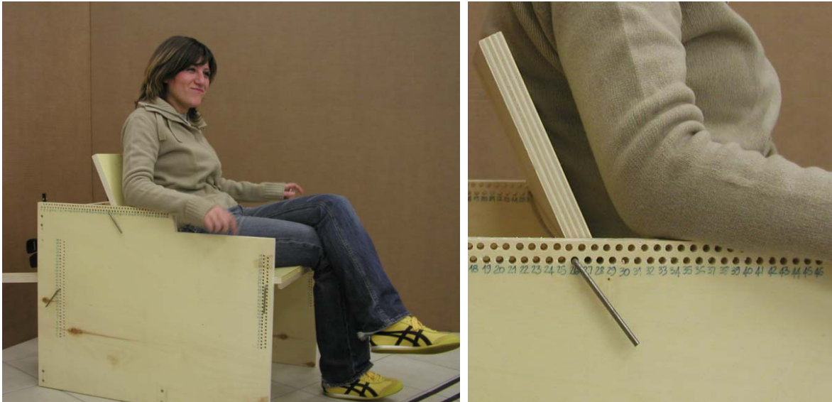
Fig. 2.31, 2.32- Macchina per sedersi. Questo strumento, progettato e realizzato in Laboratorio, permette di verificare l'ergonomia e la comodità con la possibilità di variare le dimensioni fondamentali: altezze, profondità e inclinazione della seduta; inclinazione dello schienale
