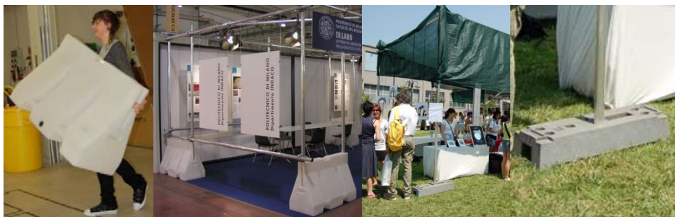
Fig. 2.67- Collage basi e New jersey: gli allestimenti self-standing sono molto comodi e non richiedono interventi sulle strutture degli edifici
