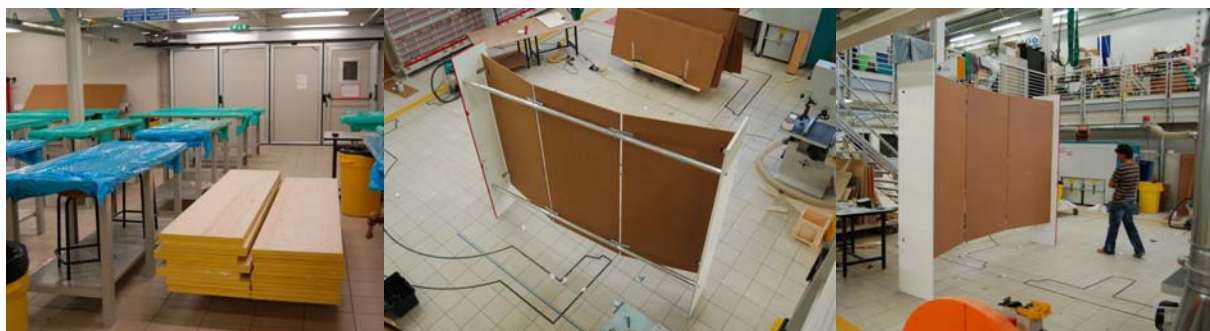
Fig. 2.51- Lab. Allestimenti, preparazione degli elementi e costruzione di un prototipo dei tritici. L'ampio spazio del laboratorio permette la costruzione di moduli per la messa a prova del carattere estetico, funzionale e statico degli allestimenti prima della versione definitiva. Possiamo definirlo: "lavorare per prototipi"
