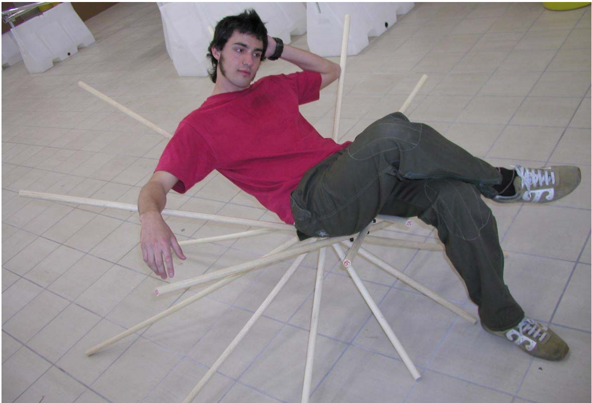
Fig. 2.33- Prototipo di seduta "richiudibile". La possibilità di sperimentare con il proprio corpo i materiali, i meccanismi e le misure in certi casi è l'unico modo per avanzare nella fase di definizione concreta del progetto
