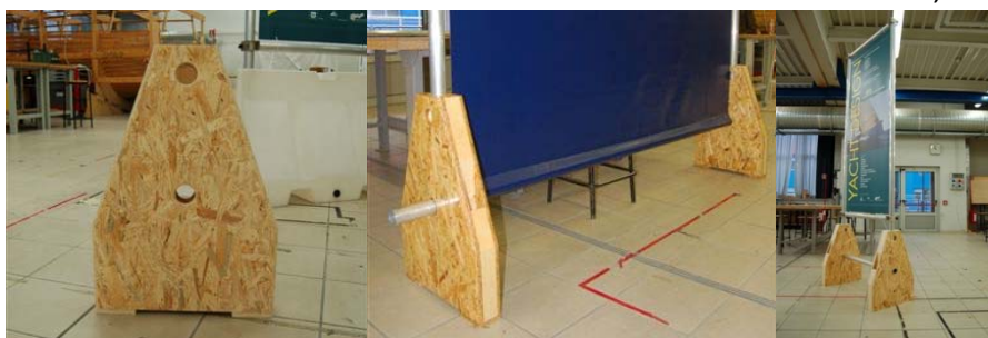
Fig. 2.73- Collage basi in OSB: sono frutto di ricerca interna. Migliore la versatilità e compattezza; sostituiscono altri basamenti e sono costruiti internamente con materiali da fonti rinnovabili
