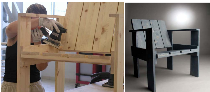
Fig. 2.33- Prototipo di seduta "richiudibile". La possibilità di sperimentare con il proprio corpo i materiali, i meccanismi e le misure in certi casi è l'unico modo per avanzare nella fase di definizione concreta del progetto
