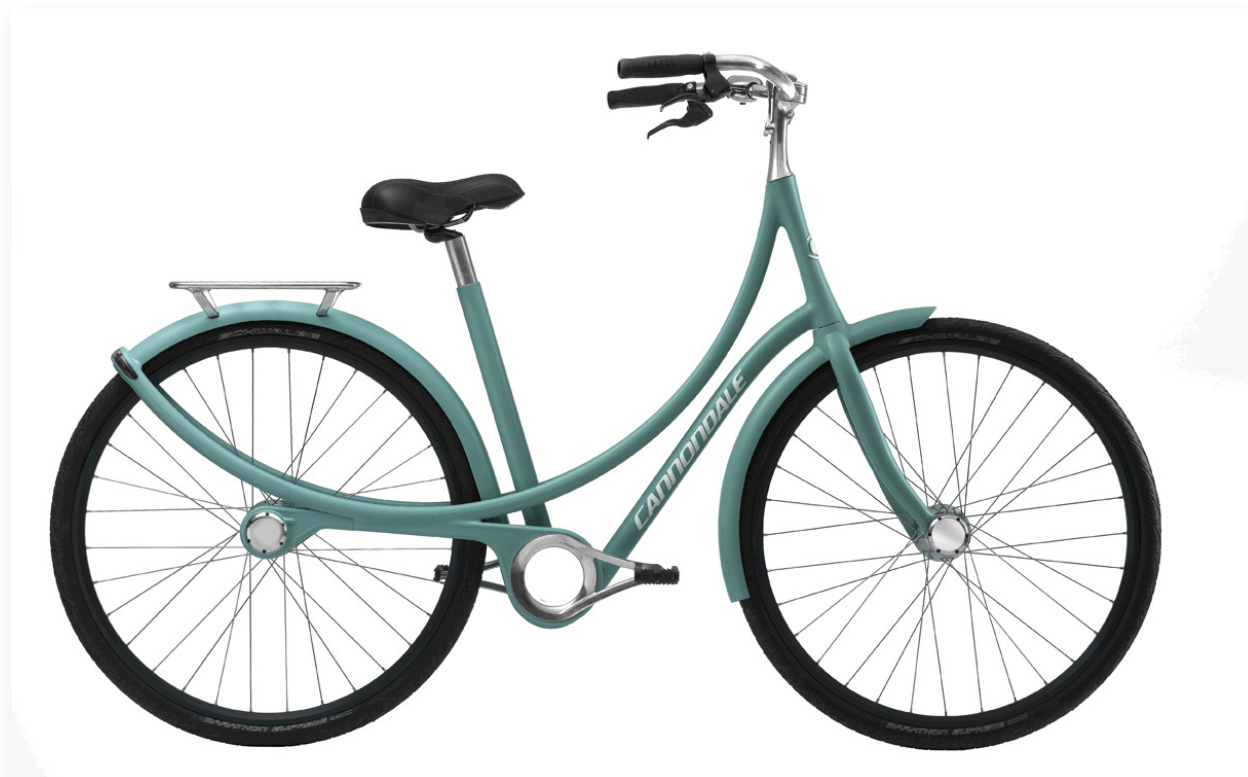
Fig.1.48 La vista laterale fa notare il gioco estetico ottenuto attraverso l'integrazione del tubo obliquo ed il portapacchi posteriore. Si notino i valori di rake e dell'angolo piantone molti accentuati.
