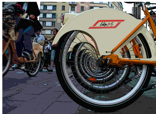
Fig. 2.33 Dettaglio della ruota posteriore, protetta da un ampio carter. Questo si raccorda con il carro ed ingloba il fanale posteriore.
