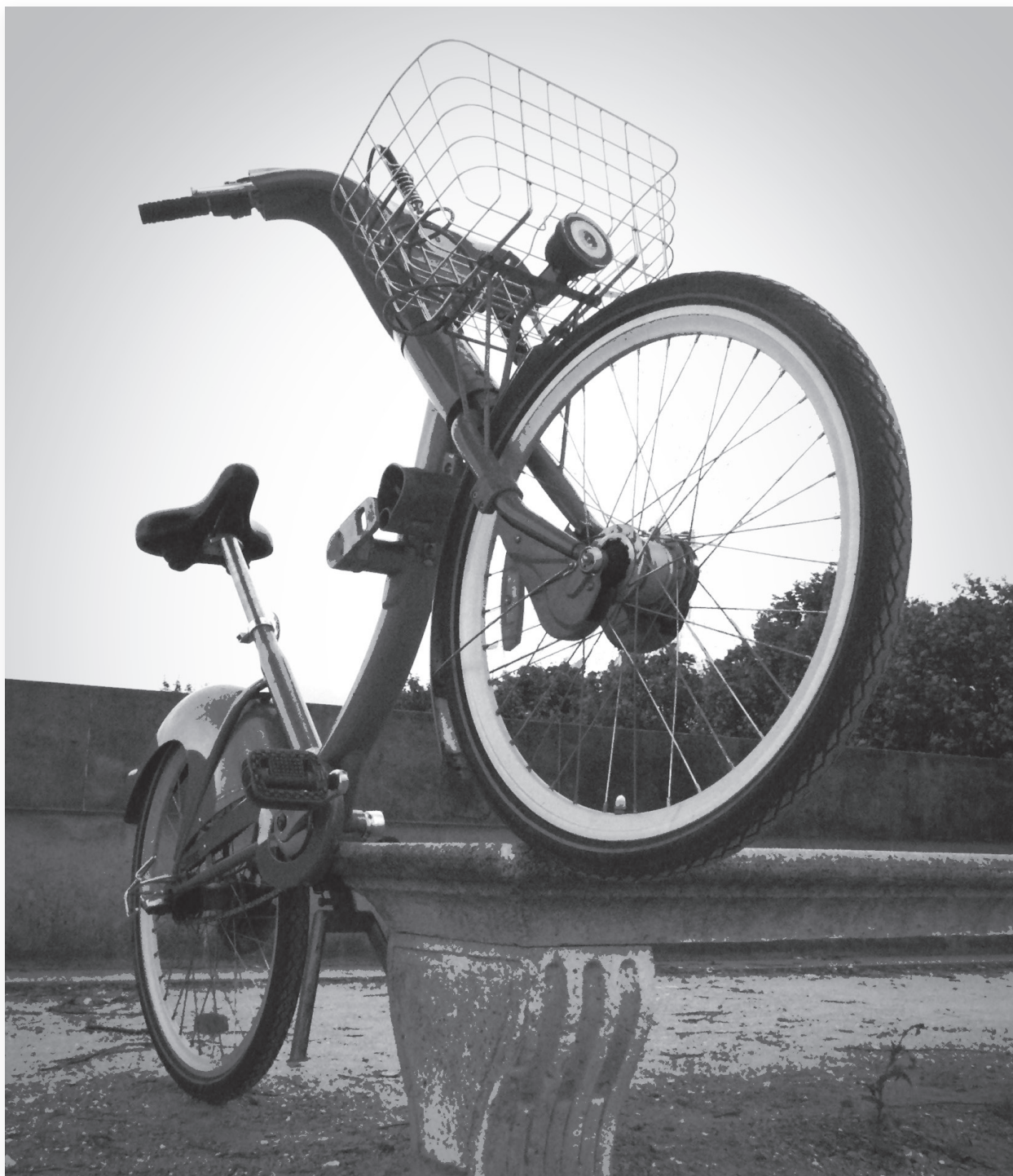
Fig. 2.14 La bicicletta utilizzata nel bike sharing parigino, il Velib'. Si noti all'altezza del tubo obliquo il sistema per l'aggancio della bici alla sede.
