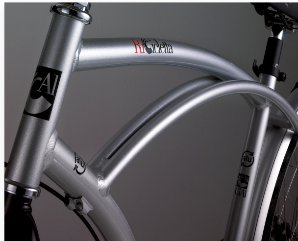
Fig.1.41 Dettaglio del carro che va ad convergere direttamente sul tubo obliquo.
