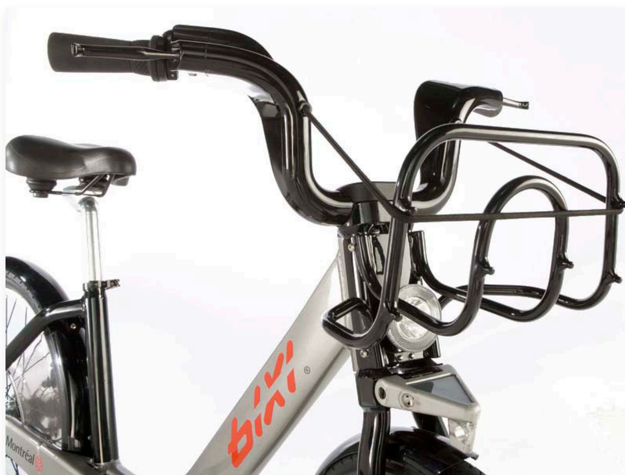
Fig. 1.23 La tipica bici del servizio Bixi: pratica e decisamente resistente grazie al telaio in alluminio.
