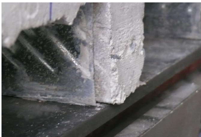
Figura 5.5.3 Scorrimento lamiera calcestruzzo
