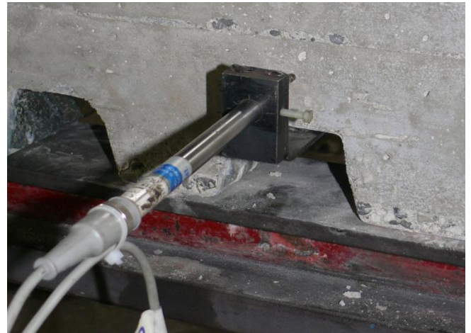
Figura 5.3.4 Particolare : squadrette per il posizionamento dei trasduttori alle sezioni di estremità
