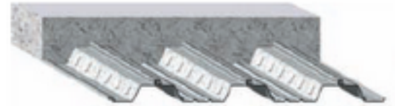
Figura 2.1.1 - Lamiera trapezoidale con bugnature
