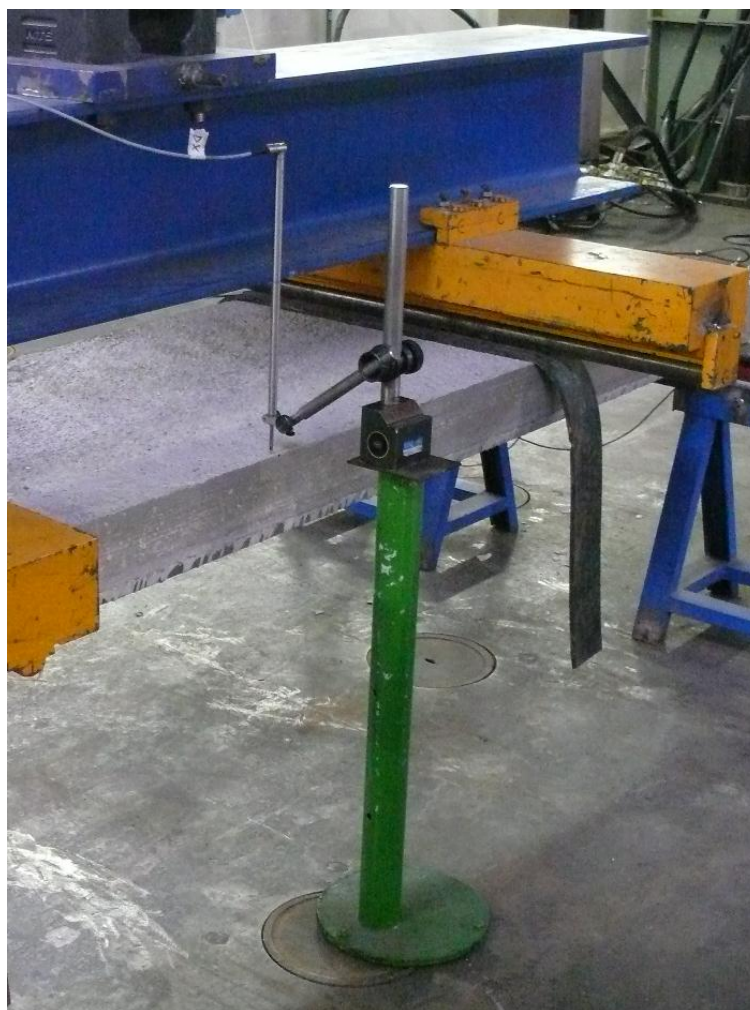
Figura 4.13–Particolare :posizione dei trasduttori per l' abbassamento in mezzeria
