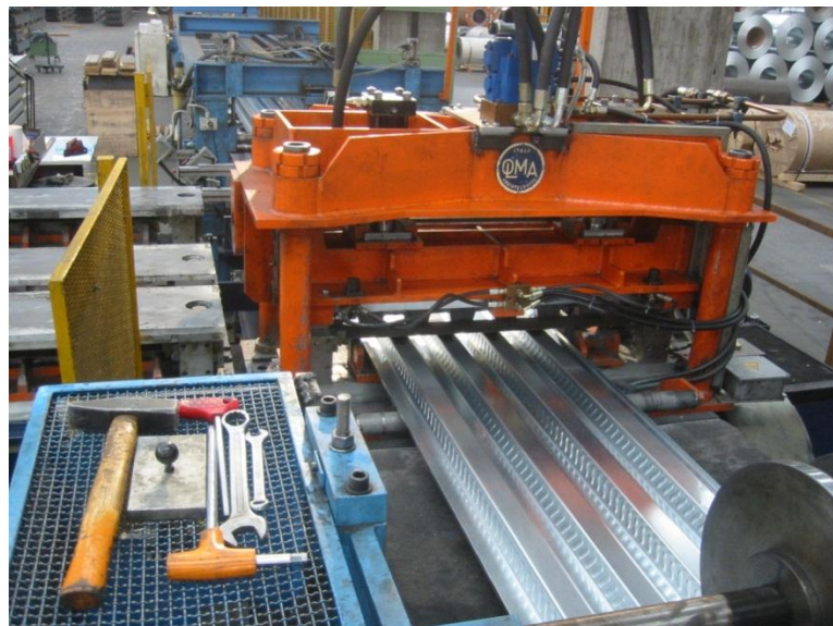
Figura 7.2.7: Lamiera alla fine del processo di lavorazione
