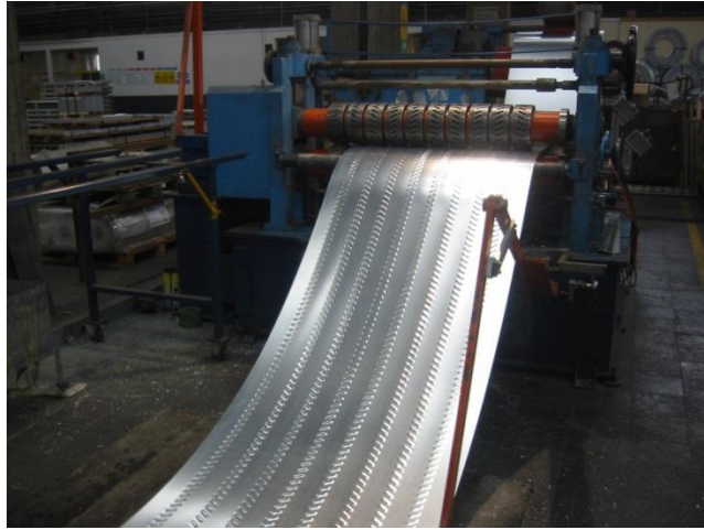
Figura 7.2.3: Lamiera all'uscita dai rulli che imprimono le bugnature
