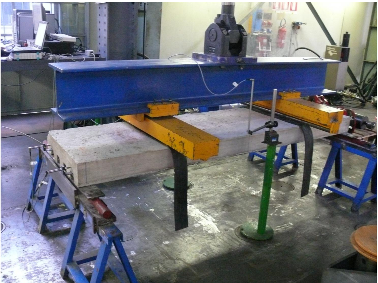
Figura 4.11 – Vista laterale della prova: particolare posizione dei trasduttori per l'abbassamento in mezzeria e per lo scorrimento relativo acciaio-clc
