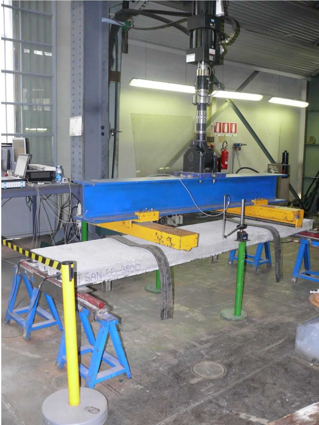
Figura 5.3.7 Soletta montata pronta per la prova
