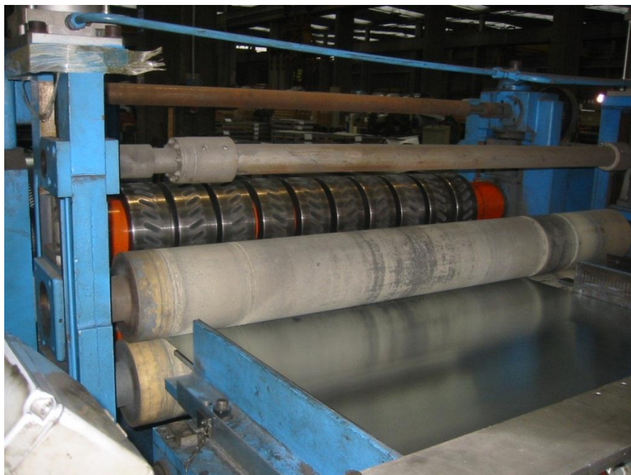
Figura 7.2.2: Fase del processo che realizza le bugnature sulla lamiera
