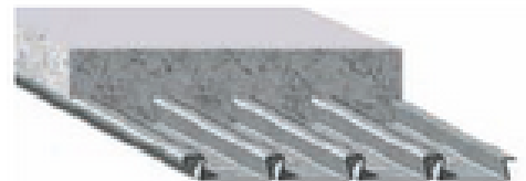
Figura 2.1.2 - Lamiera con geometria rientrante
