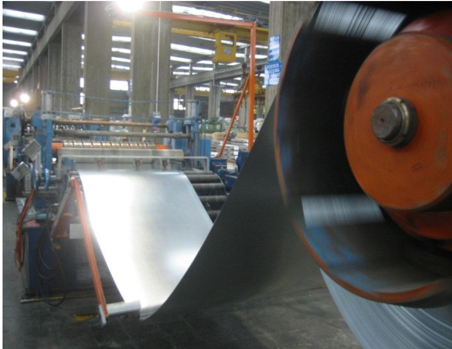
Figura 7.2.1: Nastro di lamiera piana
