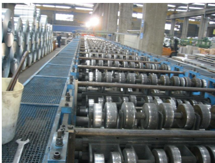
Figura 7.2.5: Serie di rulli che realizzeranno la sezione trasversale della lamiera grecata
