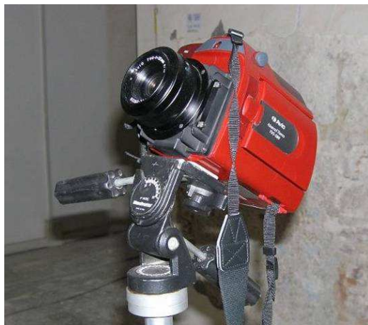
Figura 5.1 - Termocamera Avio TVS-500.
