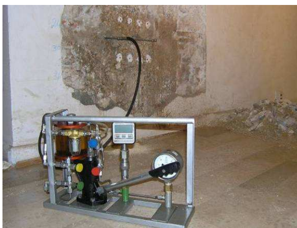
Figura 5.31 – Il sistema idraulico collegato al martinetto inserito nella muratura.
