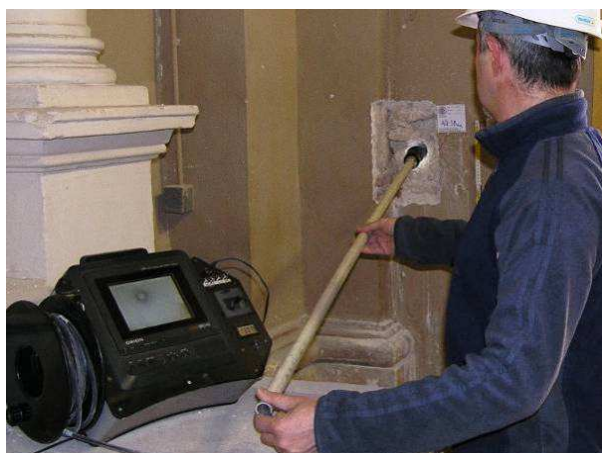
Figura 5.23 – Esecuzione di una video-endoscopia.
