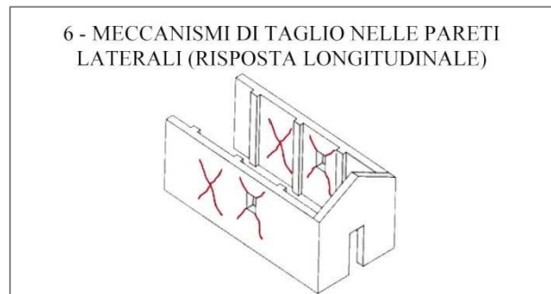
Figura 4.42– Meccanismo n°6 –meccanismi di taglio nelle pareti laterali- tratto dall'abaco dei meccanismi di collasso.
