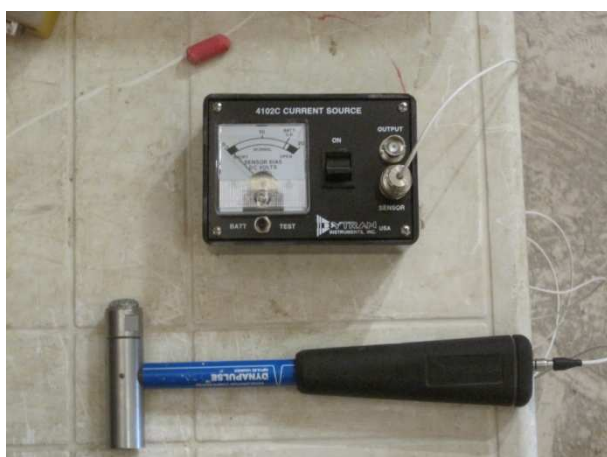
Figura 5.6 – Martello strumentato e amplificatore di segnale.
