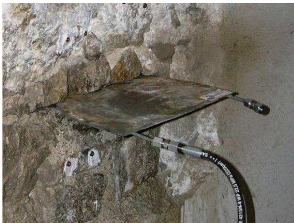
Figura 5.29 – Martinetto piatto (dim. 350 x 250 x 4 mm) utilizzato per le prove.
