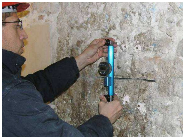
Figura 5.28 – Lettura della variazione della distanza tra le basi di riferimento dopo l'esecuzione del taglio.
