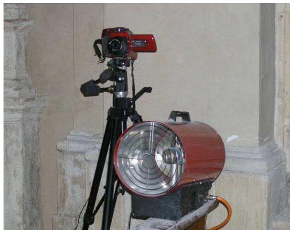
Figura 5.2 - Termoconvettore a GPL e lampada ad infrarosso da 1.5 Kw.
