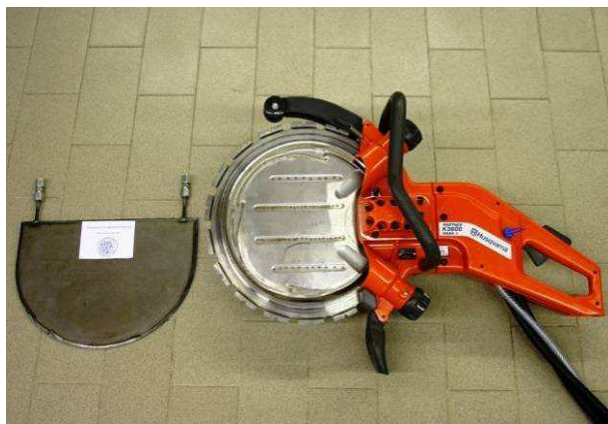
Figura 5.26 – Sega circolare a disco diamantato eccentrico.
