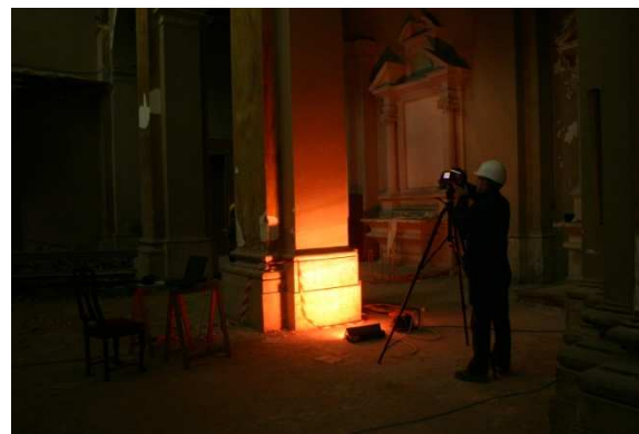
Figura 5.5 - Esecuzione della prova termografica su un pilastro.
