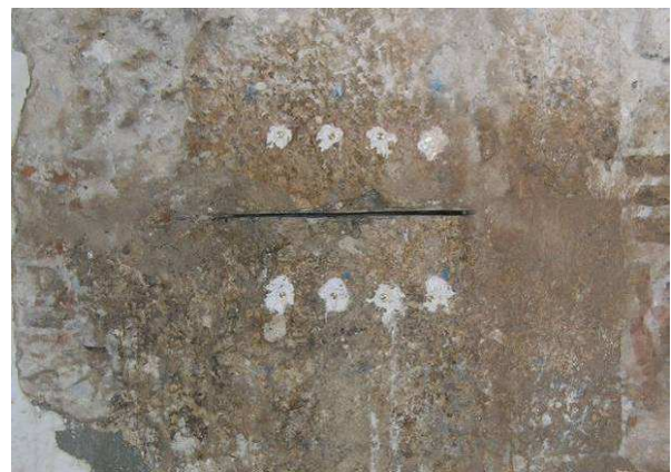
Figura 5.27 – Taglio effettuato con disco diamantato eccentrico e posizionamento dischetti invar.
