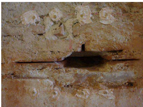
Figura 6.165 e 6.166 – Smontaggio parziale della muratura in corrispondenza del taglio della prova SB-J4S.
