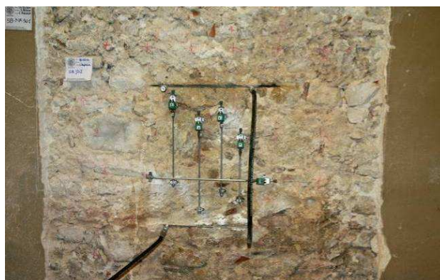
Figura 6.77 - Trasduttori LVDT applicati alla muratura.
