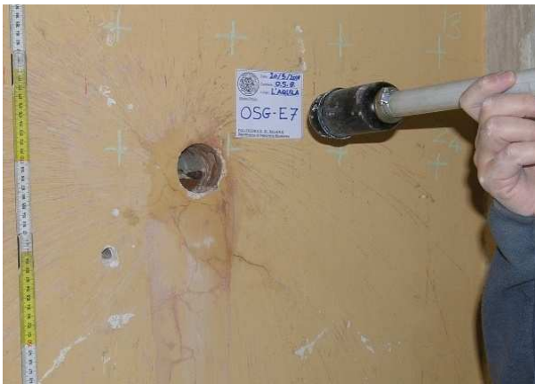
Figura 6.182 – Esecuzione della video endoscopia.
