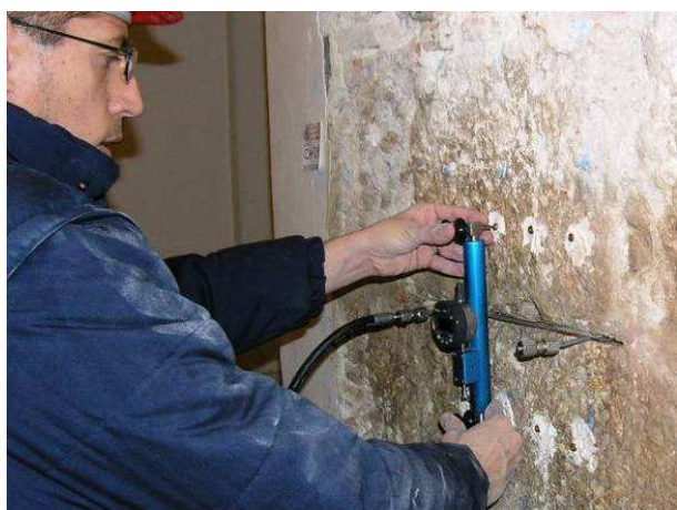
Figura 5.30 – Verifica della distanza tra i punti di riferimento dopo l'inserimento del martinetto.
