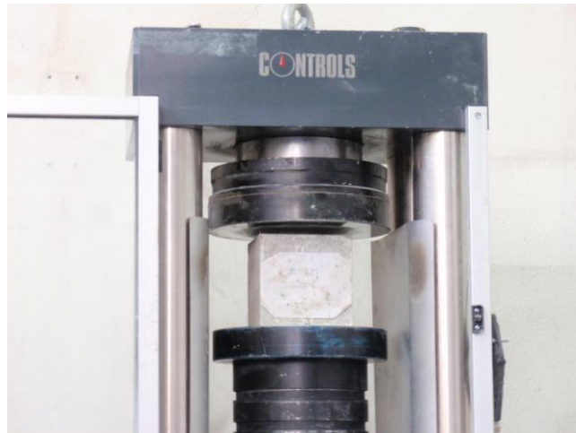
Fig. 3.16 Compression test setup, Polo Regionale di Lecco.
