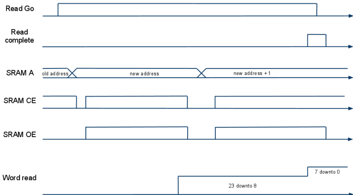
Figura 8.6 - Protocollo lettura ram
