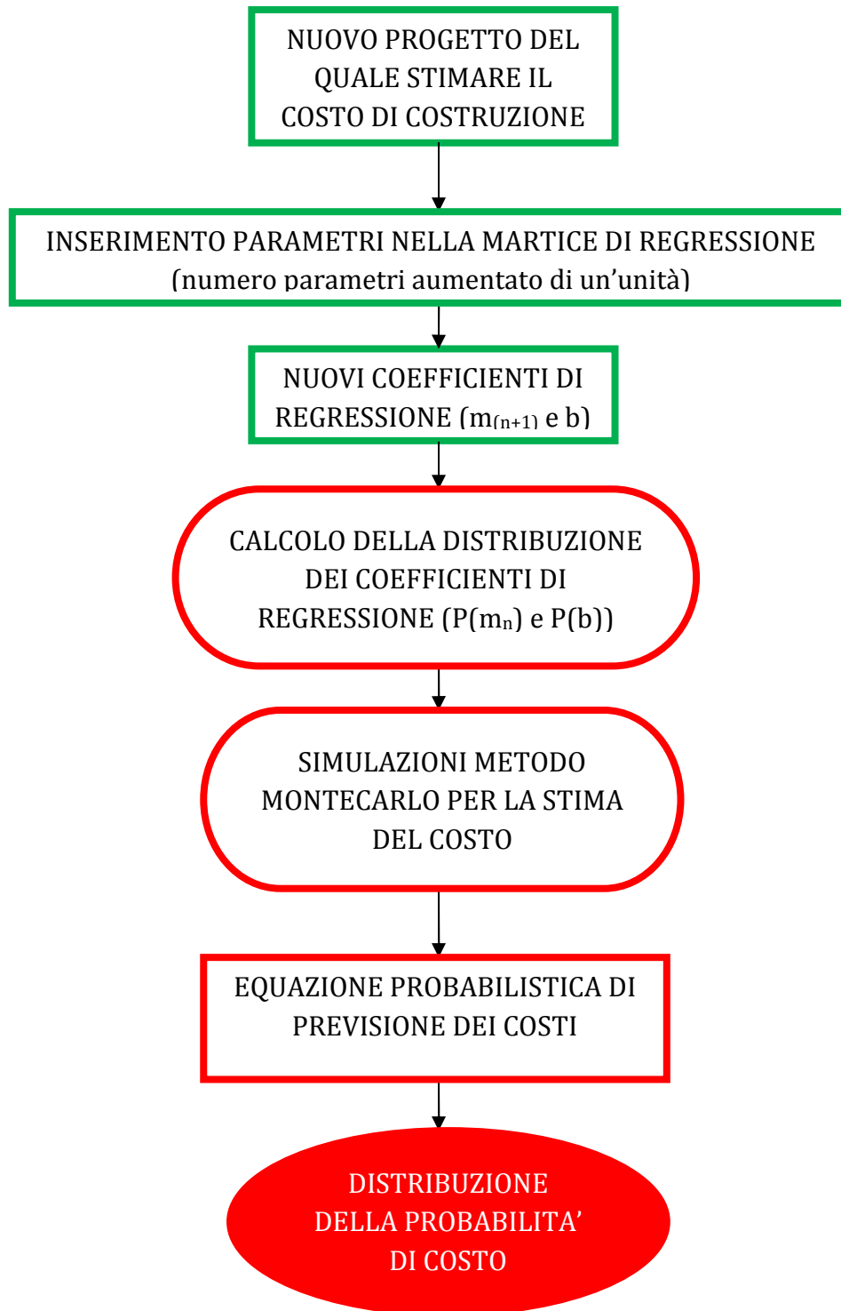
FIGURA 38: DIAGRAMMA DI FLUSSO DEL FUNZIONAMENTO MIGLIORATIVO DEL METODO – AUMENTO DEI PARAMETRI MEDIANTE AUMENTO DEL DATA-SET (METODO B)
