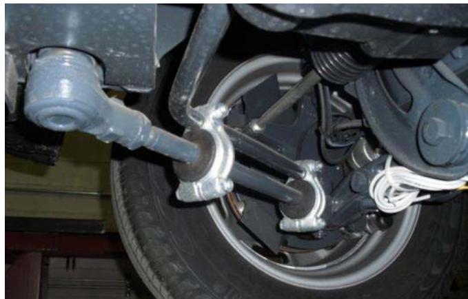
Figura 3.8. Dettaglio del triangolo inferiore e della barra antirollio.
