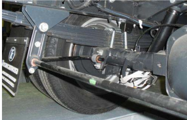
Figura 3.11. Sospensione posteriore e particolare della barra antirollio.
