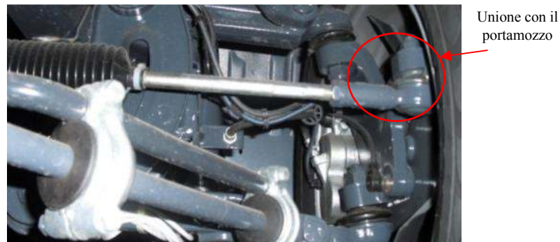
Figura 5.16. Particolare del rod che unisce la barra di direzione con il portamozzo.
