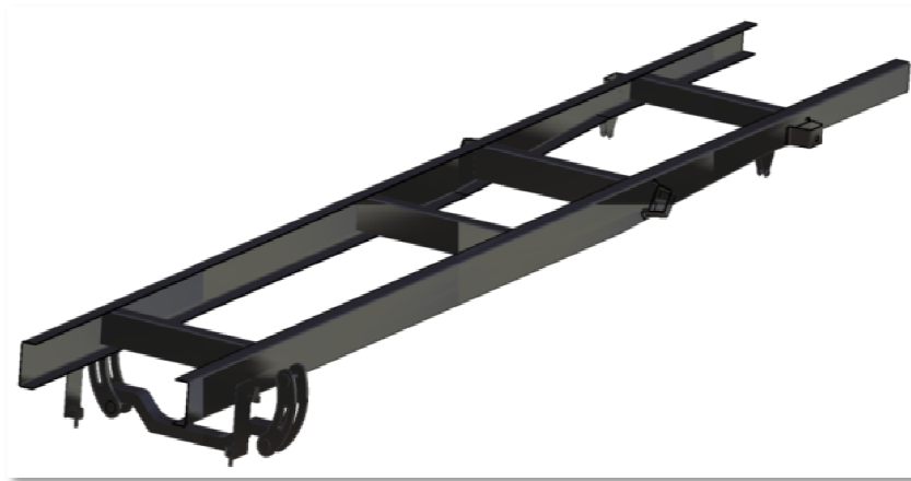
Figura 5.7. Particolare dello Chassis.
