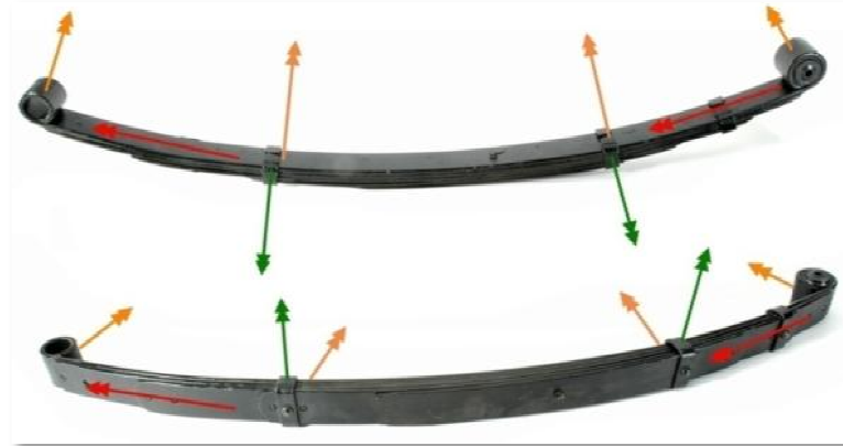
Figura 5.17. Gradi di libertà interni della balestra.
