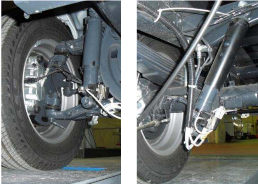
Figura 9.10. Installazione dei sensori a filo (prima della calibrazione). Sospensione anteriore (foto di sinistra) e posteriore (foto di destra).
