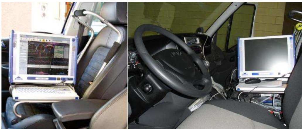
Figura 9.11. Kit de montaggio (sinistra) e DEWE-2601 nel furgone (destra).
