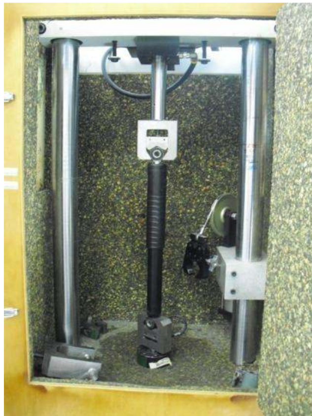
Figura 4.3. Ammortizzatore anteriore dentro la macchina di prova.
