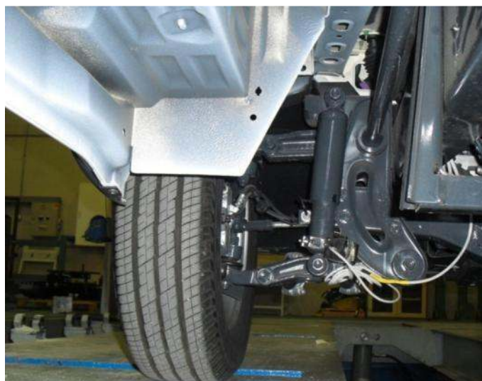
Figura 3.9. Dettaglio della sospensione anteriore e dell'ammortizzatore.
