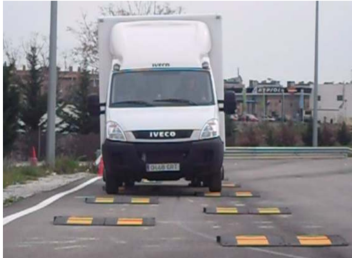
Figura 9.17. Prova per osservare il movimento di rollio.
