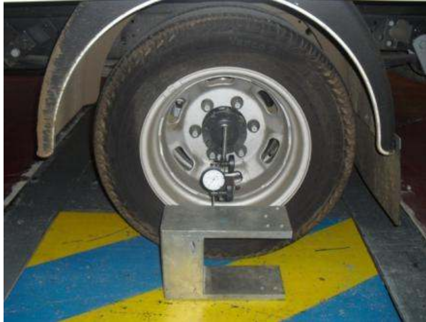
Figura 4.5. Collocazione del comparatore nella ruota dell'asse posteriore.
