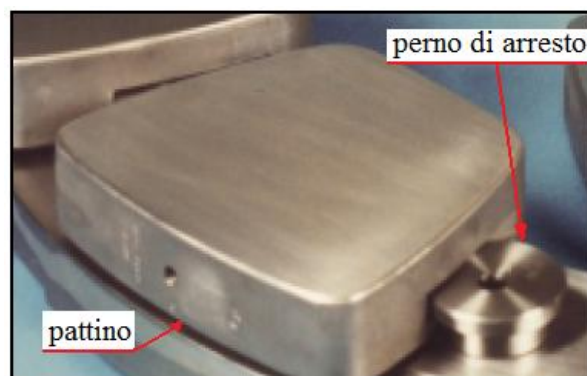
Figura 3.13. Dettaglio di un cuscinetto assiale con perno di arresto del pattino [1].
