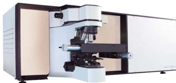
Figura C.6: Raman dispersivo LabRAM HR800 in modalità micro con microscopio Olympus BX41 e stage per misure di mapping.
