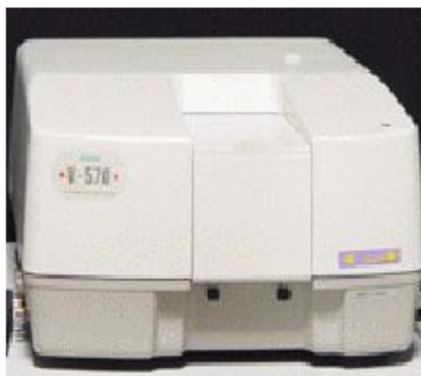
Figura C.1: Spettrometro UV-VIS della JASCO V-570: tale spettrometro fornito di lampada alogena come sorgente permette di coprire anche il range del NIR.
