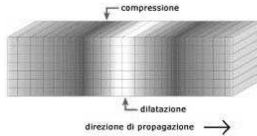
Figura 2.3- Propagazione delle onde P.
