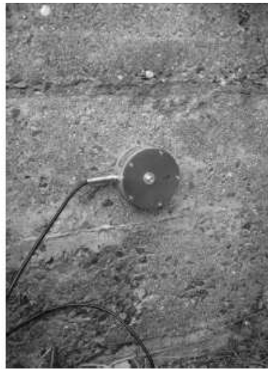
Figura 4.12 -Posizione del geofono sul rivestimento della galleria.
