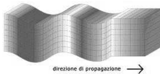
Figura 2.3- Propagazione delle onde P.
