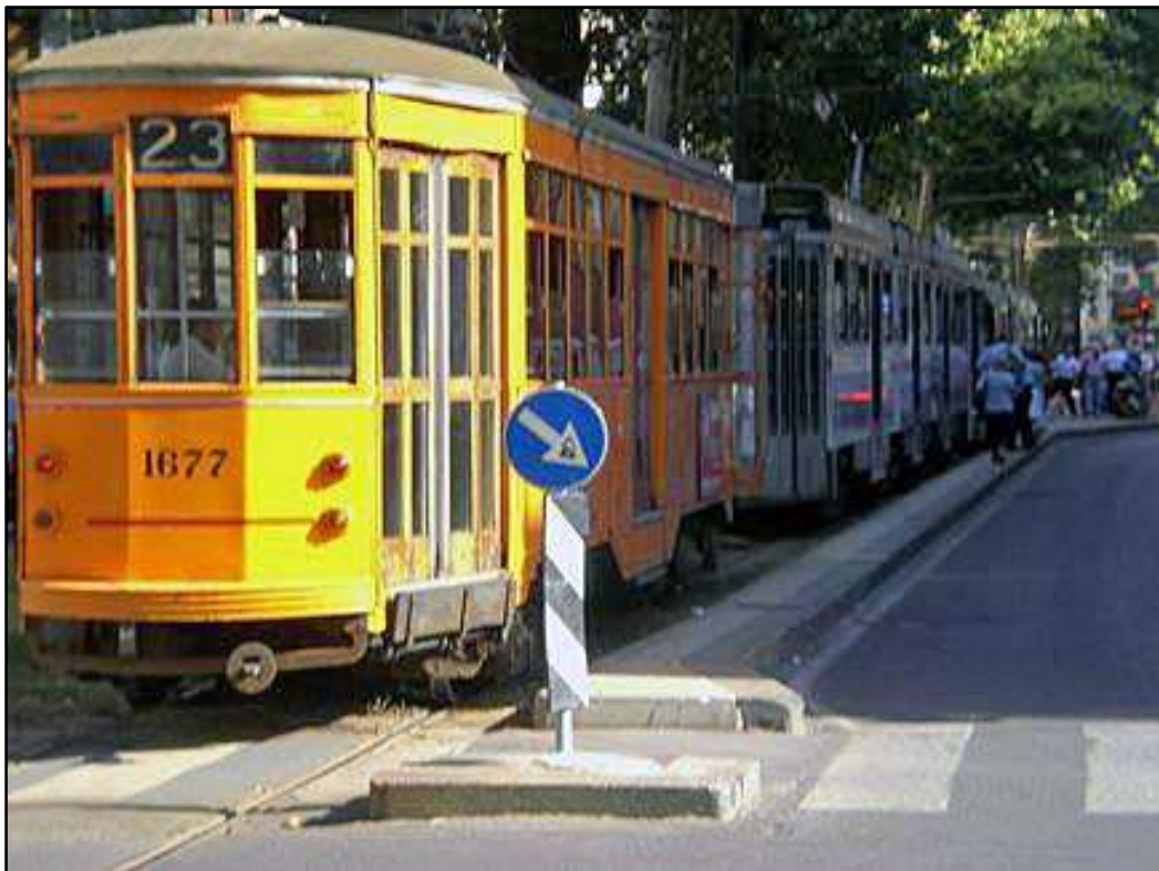
Figura 1.2.2 Un tracciato protetto (Milano): la corsia riservata al tram è separata tramite un cordolo rialzato dalle altre corsie, ma consente l'attraversamento pedonale.
