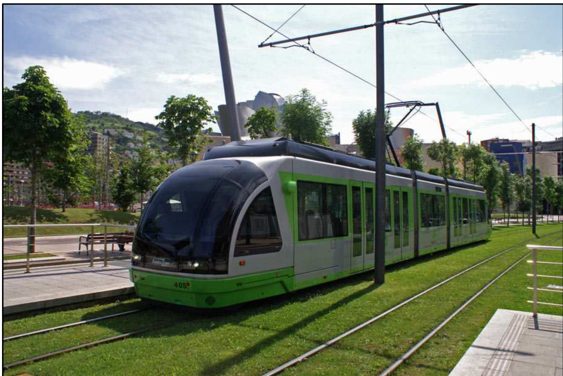
Figura 1.2.3 Una sede viaria indipendente (Bilbao): la corsia riservata al tram impedisce l'accesso a tutte le altre componenti di traffico.
