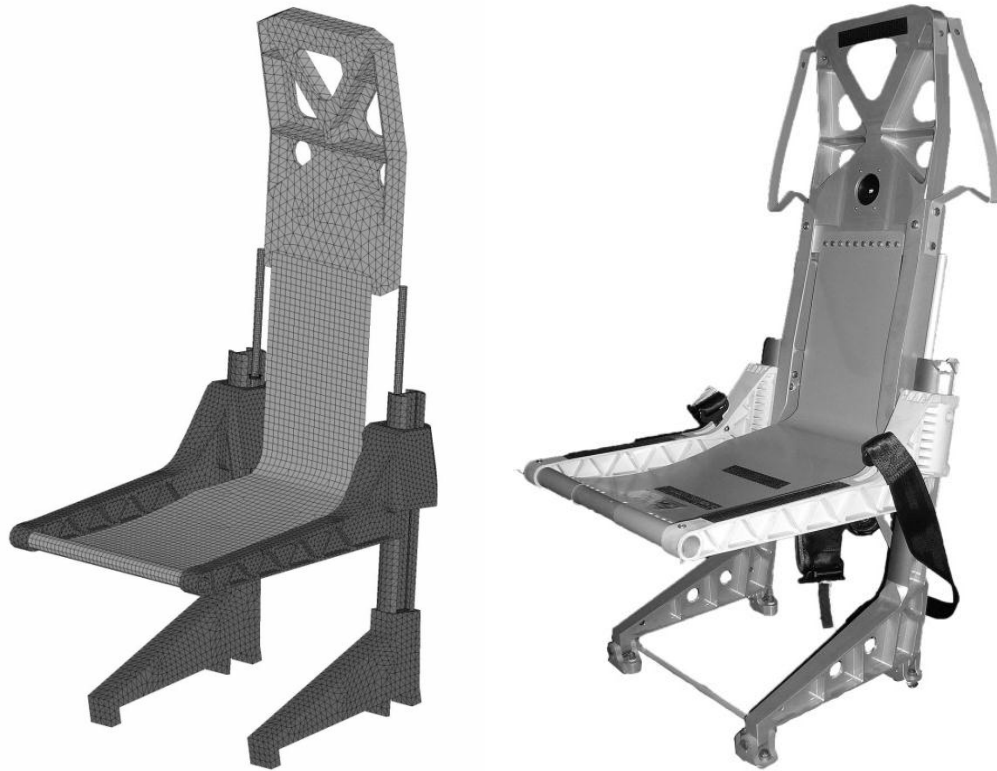
Figura 4.15 - Struttura del sedile: mesh e modello reale
