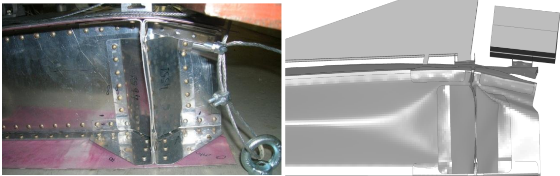
Figura 4.38 - Confronto deformata incrocio posteriore destro
