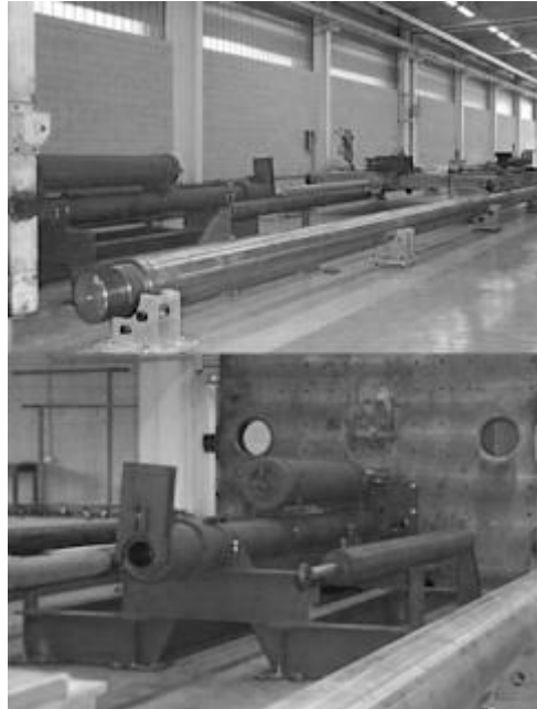
Figura 3.2 - Dettagli slitta orizzontale impiegata per la prova
