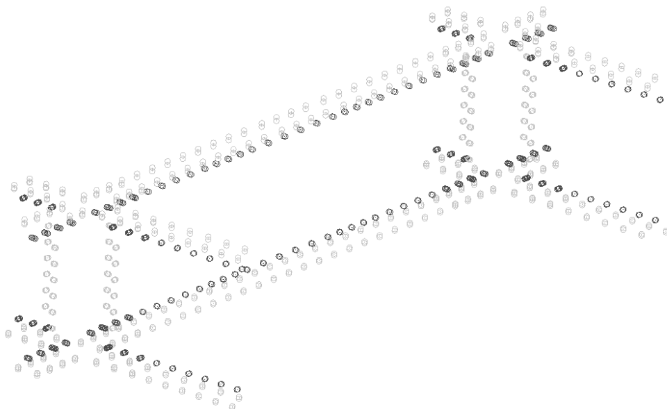
Figura 3.8 - Disposizione e tipologia ribattini
