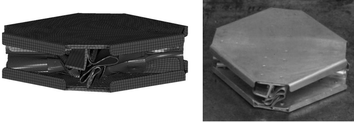
Figura 2.38 - Confronto numerico sperimentale della fase finale dello schiacciamento
