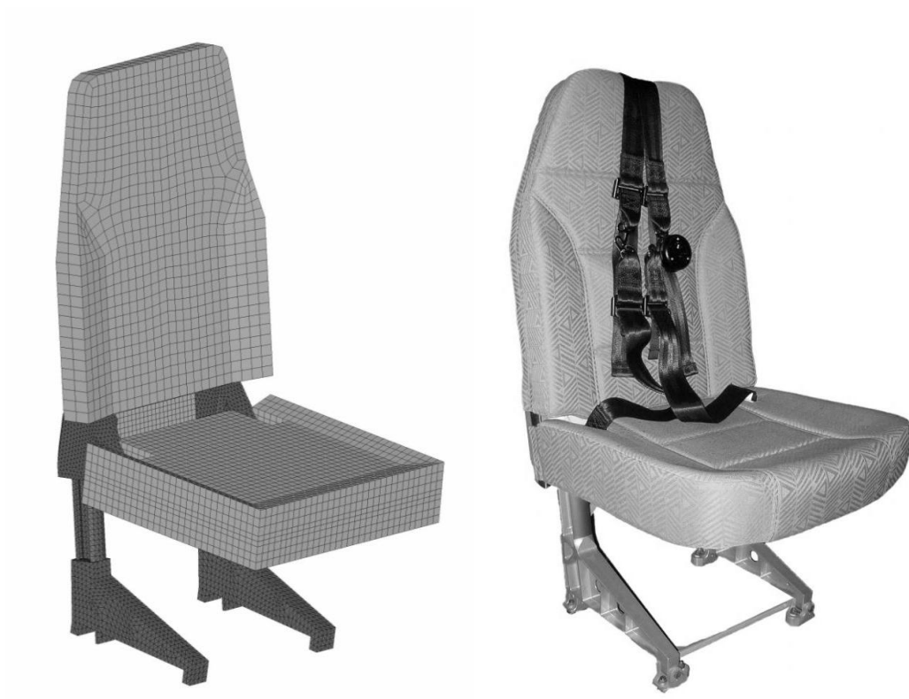
Figura 4.20 - Sedile: modello reale e numerico
