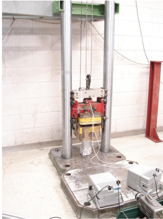
Figura 2.4 - Macchina di prova per schiacciamento dinamico
