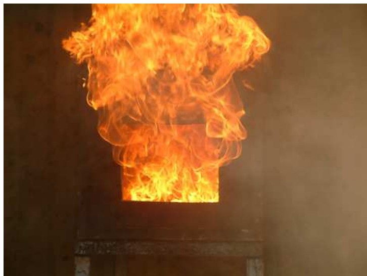
Figura 5.13: Fenomeno di “flashover”
