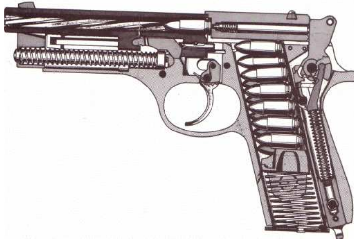
Figura 4.1: Sezione di pistola Beretta® 92
