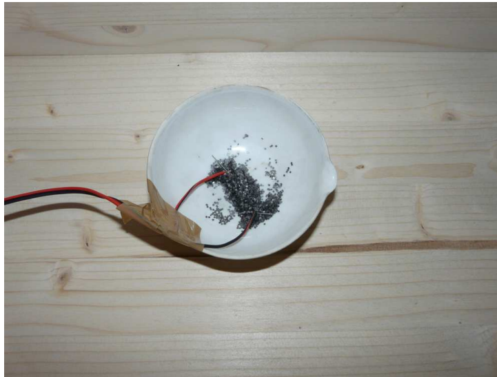
Figura 6.9: Sistema di innesco elettrico delle polveri
