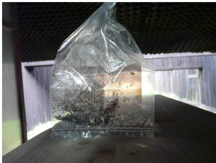
Figura 6.12: Reperto polvere incombusta
