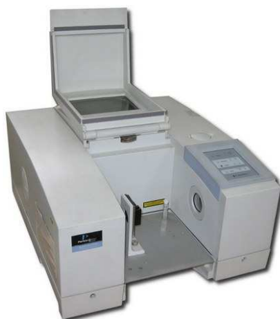
Figura 5.9: Spettroscopio all'infrarosso in trasformata di Fourier
