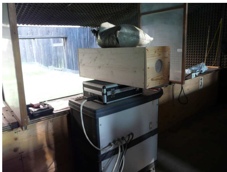
Figura 6.1: Scatola in compensato ligneo ignifugato: vista esterna
