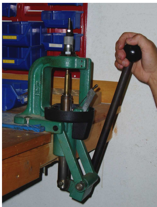
Figura 6.16: Pressa manuale per la ricarica
