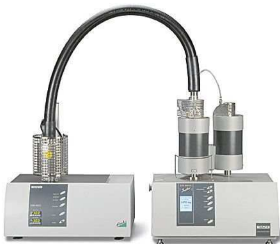
Figura 5.11: Spettrometro di massa
