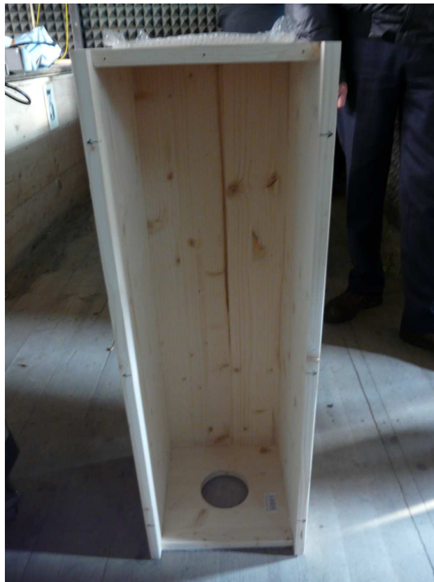
Figura 6.2: Scatola in compensato ligneo ignifugato: vista interna
