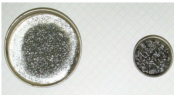
Figura 6.14: Polvere della cartuccia originale e di quella ricaricata
