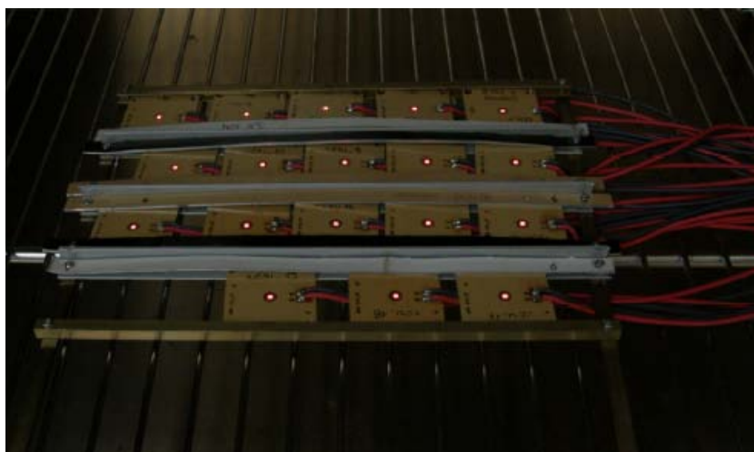
Figura 5.14. Setup sperimentale: celle in camera climatica.
