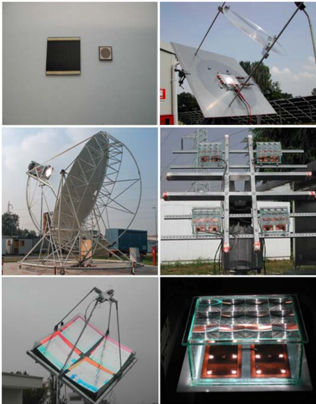
Figura 5.2. Celle a concentrazione solare e varie tipologie di moduli concentratori (CESI).
