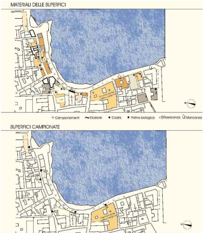
Fig. 6.72 Edilizia di bordo sul mare, mappatura dei materiali di facciata e della patologie di degrado prevalenti, e localizzazione delle superfici campionate
