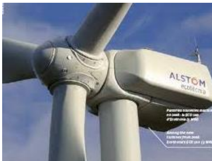
Figura 2.7 – Generatore ad asse orizzontale.
