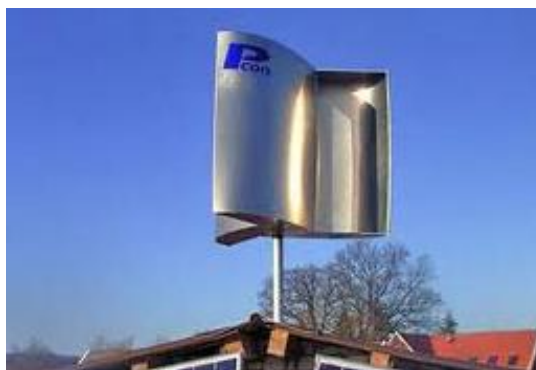
Figura 2.13 – Fotografia di un aerogeneratore Savonius installato.
