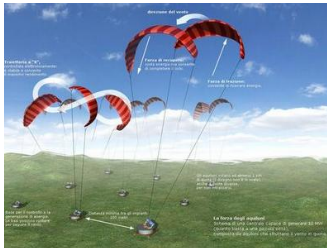
Figura 2.24 – Funzionamento di un Kite Wind Generator.
