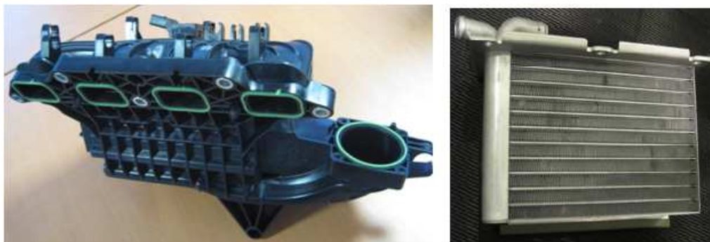
Figura 6.15. Immagine della carcassa esterna del plenum di aspirazione; a lato l'intercooler progettato per essere posto al suo interno.
