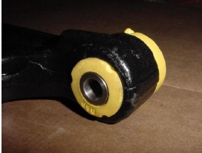
Figura 5.37: Silent-block con la parte in teflon colorata di giallo
