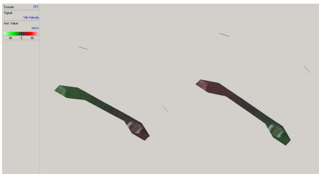
Figura 5.11: Fotogrammi del massimo e minimo presi dall'animazione dello spostamento assiale delle pastiglie al 4° ordine
