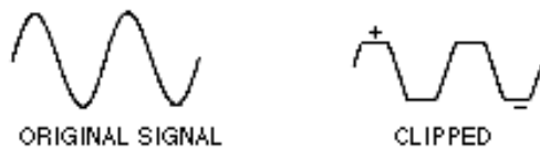
Figura 14: tecnica del peak-clipping . La parte di segnale al di sopra della soglia prestabilita viene letteralmente rimossa.
