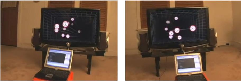
**Figura 5.36.** Esempio di Head Tracking per Desktop VR Display che utilizza il Wii-Remote. La scena si modifica a seconda del punto di vista da cui la si osserva.
