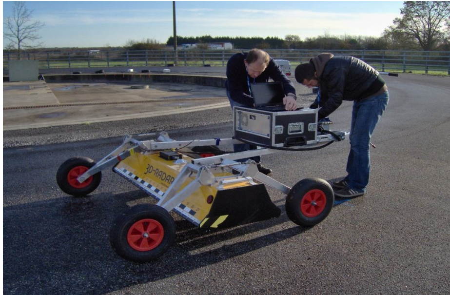
Figura 3.2 - Fase di montaggio del sistema GeoScope TM utilizzato a Nantes
