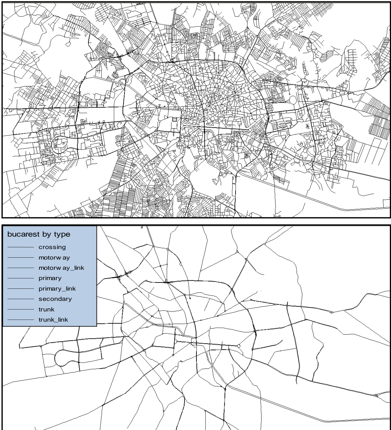
Figura 8. Confronto tra la rete completa e la rete che mantiene solo le categorie indicate in legenda
