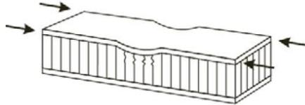
Figura 5.11: Cedimento a compressione delle pelli e del cuore.
