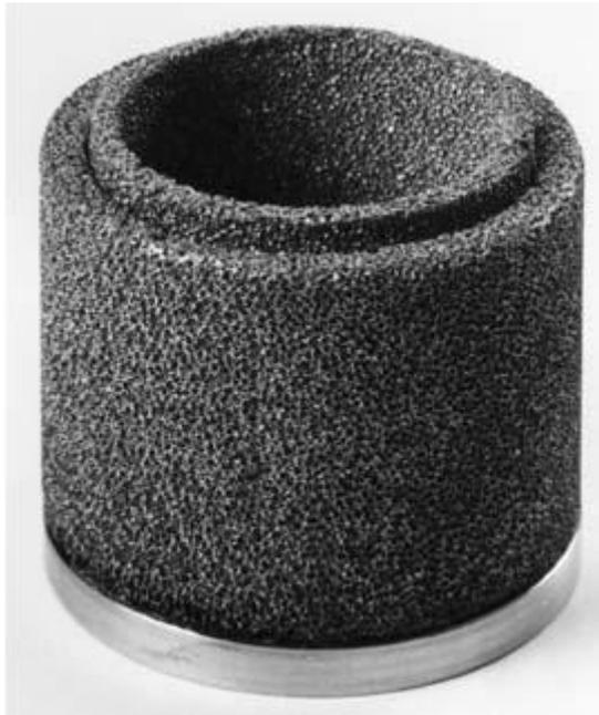
Figura 4.16: Componente realizzato con la schiuma metallica RECEMAT.
