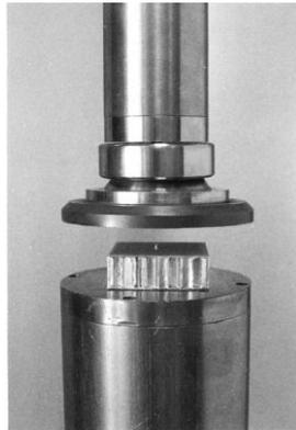
Figura 5.2: Cuore posizionato tra i piatti della macchina per eseguire la prova di compressione.
