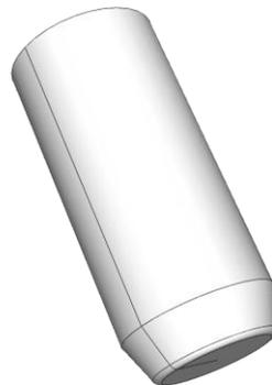
Figura 7.33: Geometria del proiettile della prova FOPS di secondo livello.
