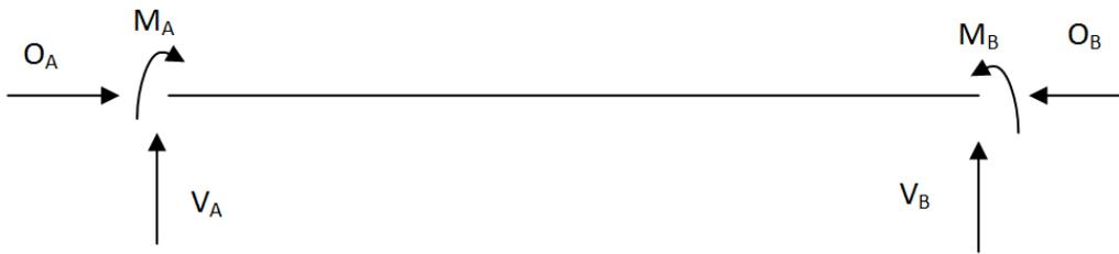
Figura 7.45: Schema delle reazioni vincolari della trave.
