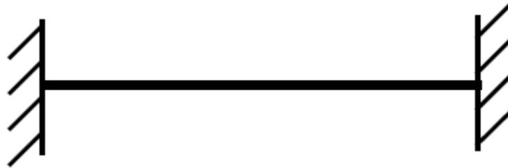
Figura 7.43: Schema grafico di una trave con doppio incastro. La trave è definita tre volte iperstatica.
