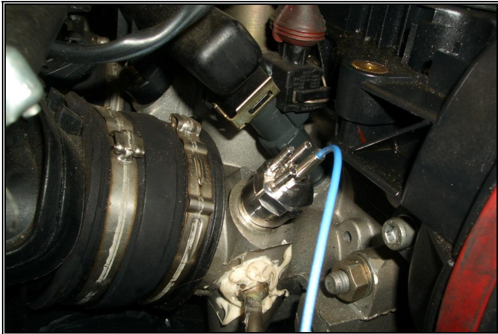
Fig. 3.7 : Immagine che mostra il posizionamento dal sensore di pressione dell'aspirazione.
