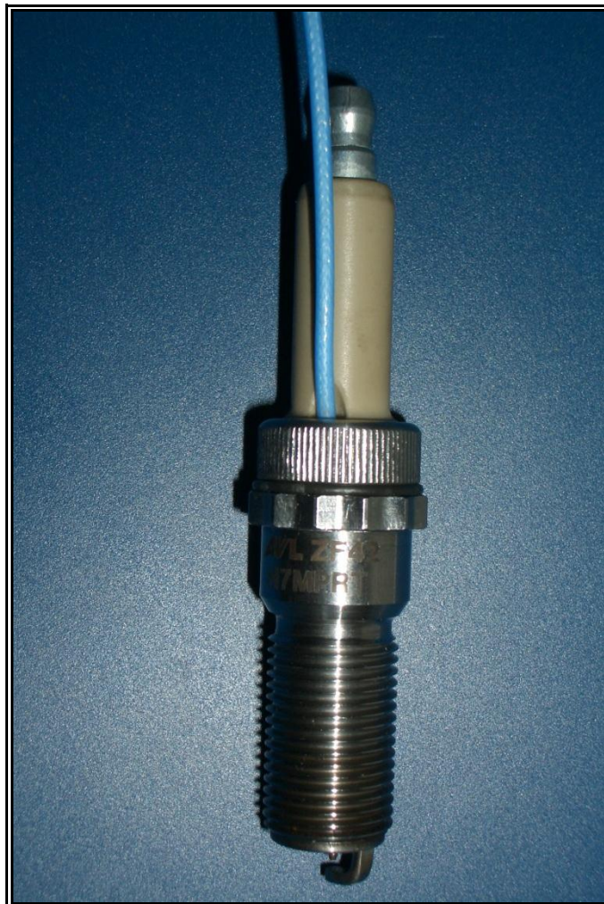
Fig. 3.3 : Immagine della candela strumentata utilizzata sul motore Alfa nella sala prove.
