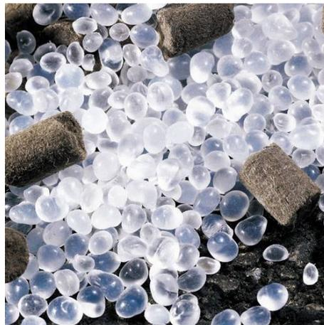
Figura 4: Il SUPERPALST un polimero amorfo che si presenta in granuli semimorbidi e flessibili. E' utilizzato per la produzione di tutti i conglomerati bituminosi in cui debba essere effettuata una modifica del bitume, allo scopo di poter migliorare le caratteristiche ed aumentare le resistenze meccaniche della pavimentazione.
