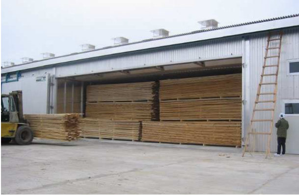
Fig.21. Stagionatura artificiale del legno
