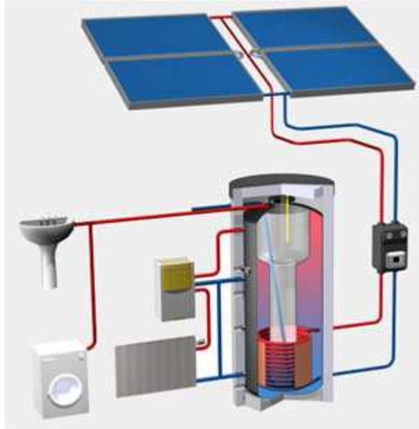
**Figura 1.4:** Schema di un impianto solare termico
