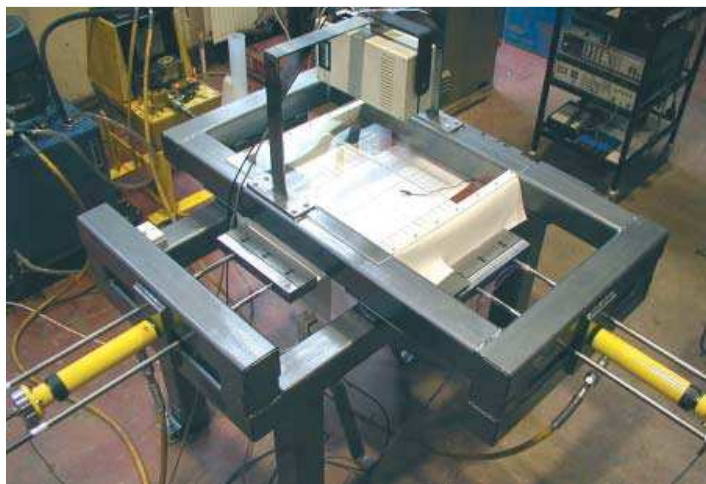
Figura 2.5: macchina di prova basato sul design "fluttuante" dell'Università di Newcastle
