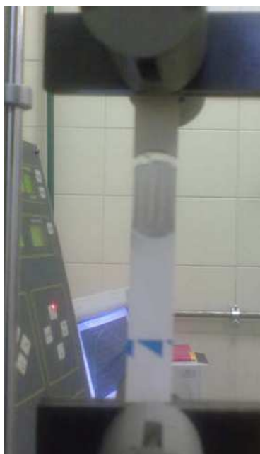
Figura 4.10: prova di trazione su un campione simmetrico
