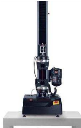
Figura 4.2: sistema di prova a colonna singola "Instron 5944"
