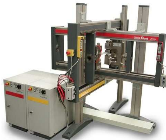
Figura 2.2: macchina per test biassiale prodotta da Zwick GmbH ( www.zwick.com )
