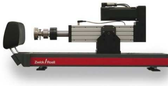
Figura 2.4: attuatore elettromeccanico prodotto da Zwick GmbH ( www.zwick.com )
