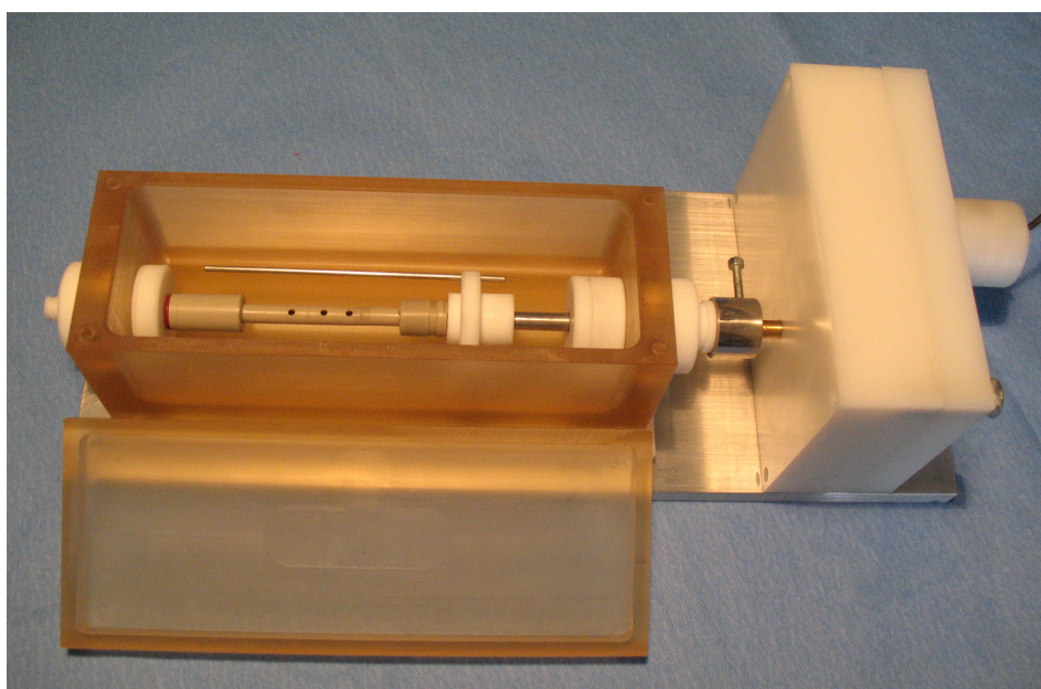
Figura 2. Foto del bioreattore assemblato. È ben visibile la camera di coltura ed il coperchio (parti gialle), l'albero su cui viene alloggiato lo scaffold (al centro in grigio) e uno dei due agitatori del medium (barretta metallica parallela all'albero).
