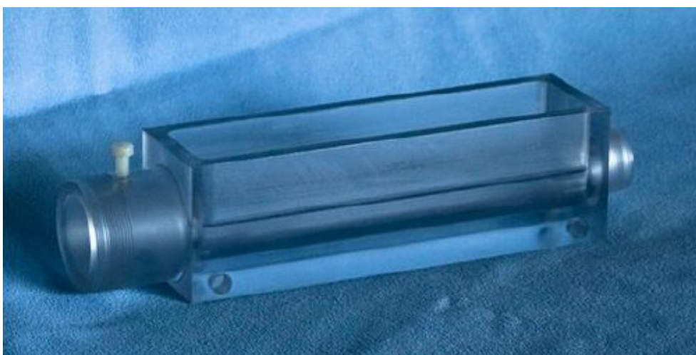
Figura 1.17. Camera di coltura del bioreattore per i piccoli vasi.
