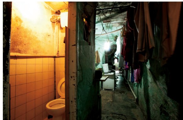
I servizi igienici sono comuni a più unità abitative e di norma sono collocati in fondo al corridoio di distribuzione. Quest'ultimo in alcuni casi viene coperto con delle lamiere, in modo da creare un ulteriore spazio riparato per la vita domestica.
